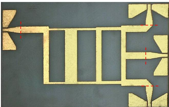
Fig. 6. Híbrido 180° fabricado en Alúmina, marcado en rojo se encuentran los planos de calibración en la medida.
