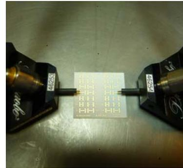
Fig. 7. Calibración en sondas con el kit KTRL.
