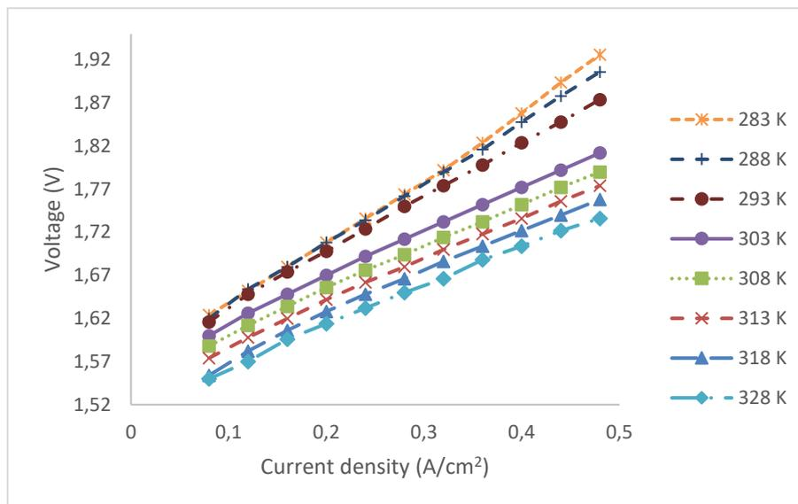
**Figura 1** Curva de polarización a diferentes temperaturas.
