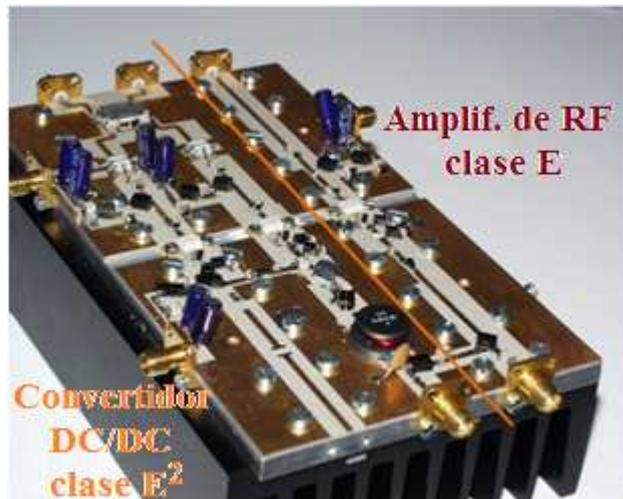
**Figura 3.7** Detalles de implementación e integración de las etapas de potencia del transmisor (convertidor, filtro reconstructor y amplificador de RF).
