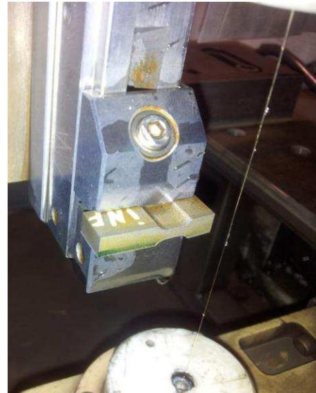
Fig. 2. Rebanado de uno de los prismas para obtener miniprobetas de tracción.
