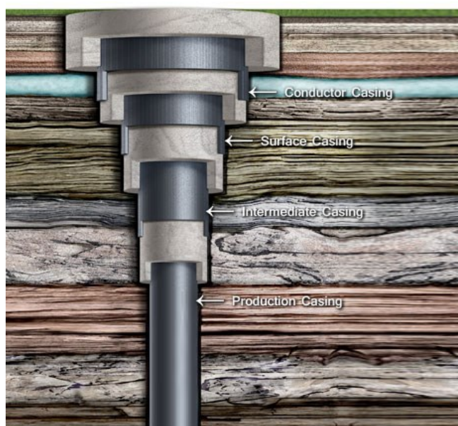
Figura 2.10. Esquema de las diferentes etapas de perforación de pozos de gas natural. Fuente: shalemediagroup.com.
