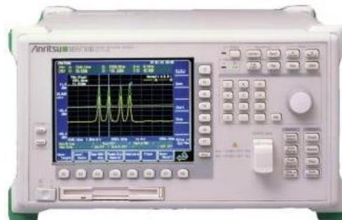
Figura 2.3: Analizador de espectros ópticos.
