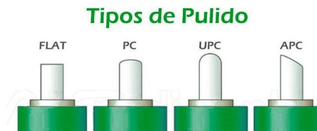
*Figura 2.6: Diferentes tipos de pulido en fibra óptica.*
