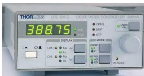
Figura 2.1: Controlador de Corriente LDC200C
