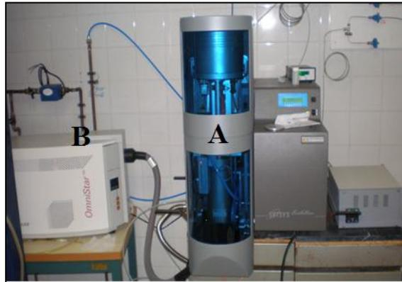
**Figura 2.1.** Equipo termogravimétrico (A) y conectado en serie a un espectrómetro de masas (B).
