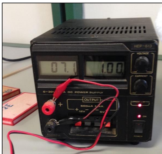
Figura 57 Alimentador de corriente con las condiciones aplicadas al ensayo
