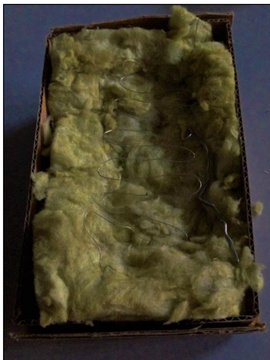
Figura 56 Hilo conductor rodeado de aislante.
