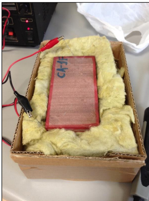
Figura 58 Muestra de arenisca CA-1F, encima del hilo conductor, realizándose el ensayo
