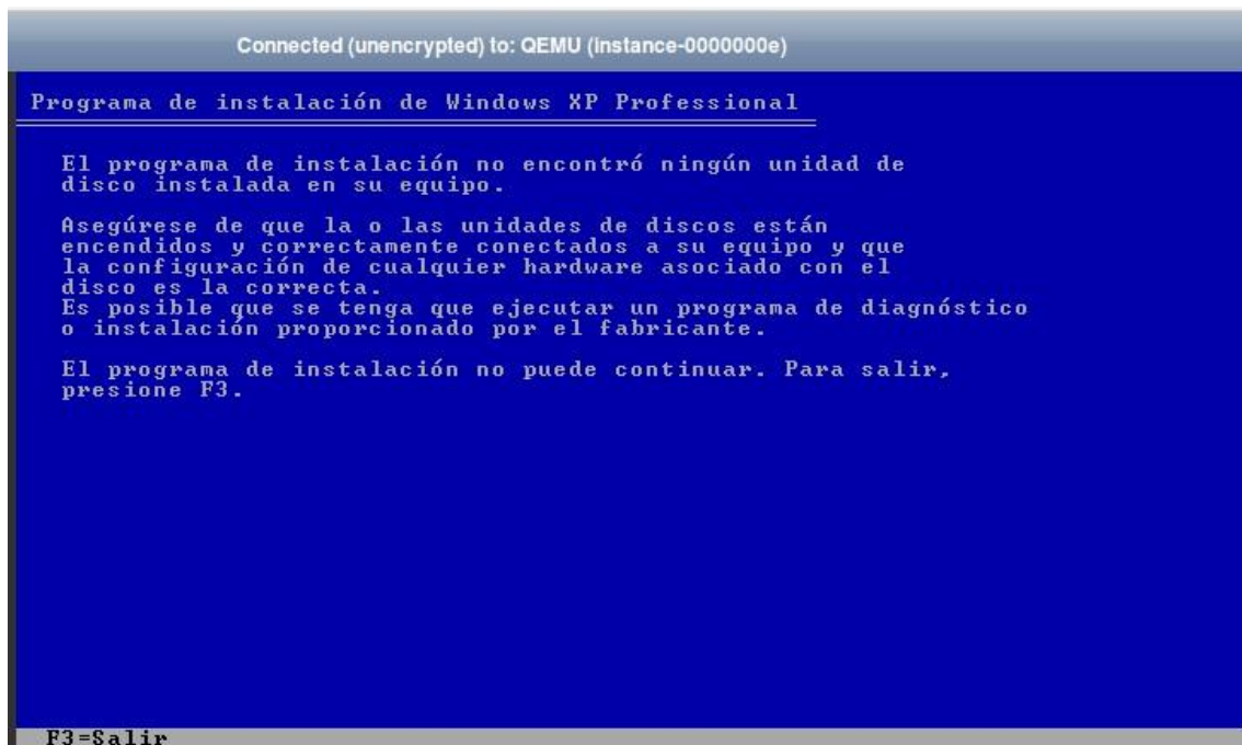
Figura 31: Mensaje de error en la instalación de XP en la instancia de OpenStack
