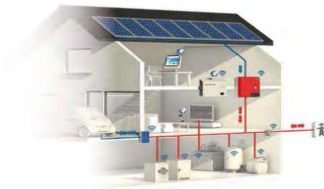
La batería integrada de iones de litio tiene una capacidad efectiva de unos 2 kWh.
