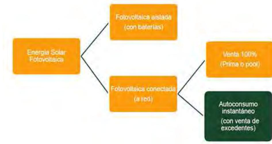
**Figura 4.** Tipologías de sistemas fotovoltaicos. Fuente: Sofos energía. [www.sofos.es](http://www.sofos.es)
