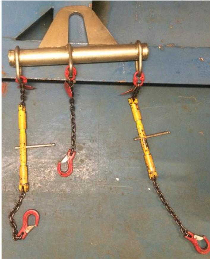
Imagen 23. Útil para la extracción y colocación de la culata.
