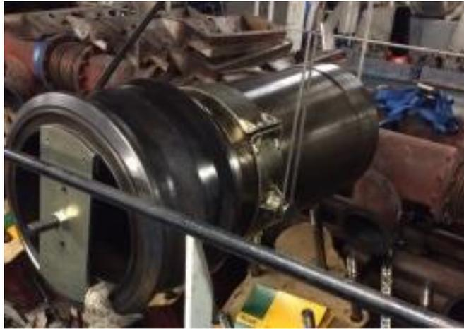
Imagen 22. Camisa extraída del motor con los útiles de sujeción.
