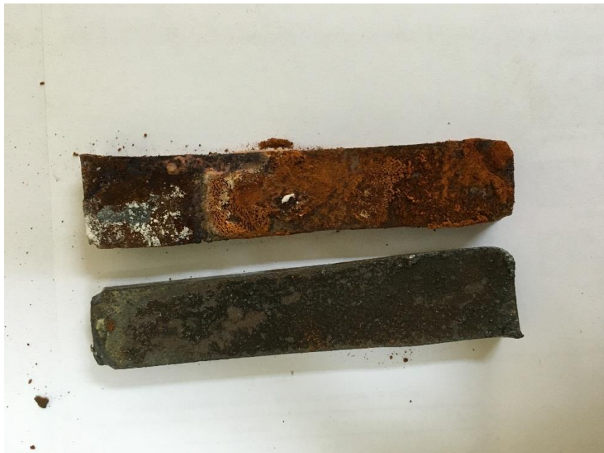
Figura 28: Fallo adhesivo intermedio
