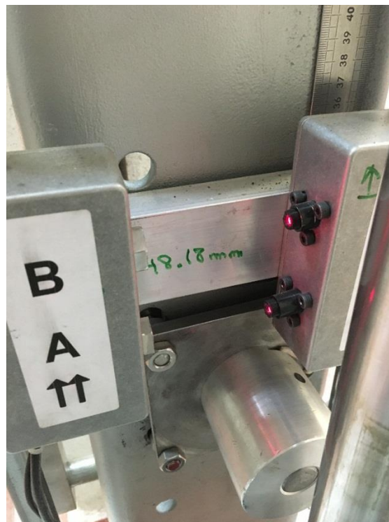
Figura 16: Láser utilizado para la alineación de las barreras
