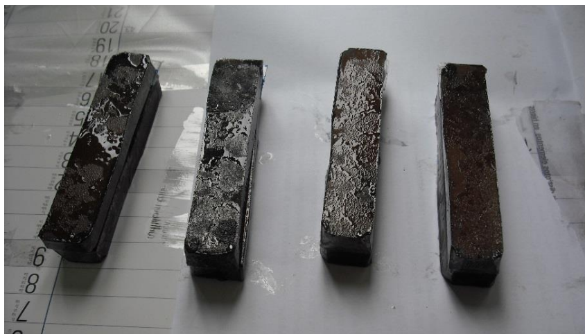
Figura 9: Probetas en proceso de secado una vez se ha aplicado el adhesivo
