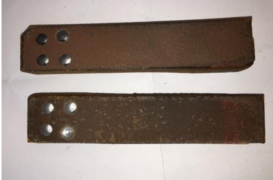
Figura 27: Fallo adhesivo no deseable
