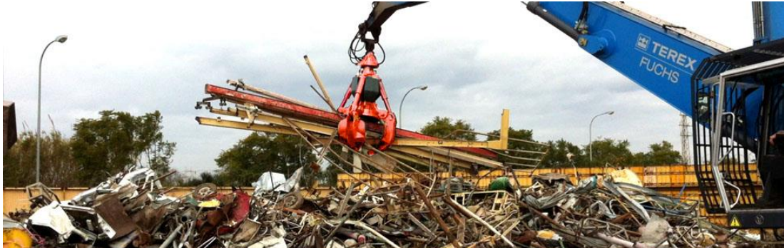
Figura 17. Grúa de gancho pulpo seleccionando chatarra.
