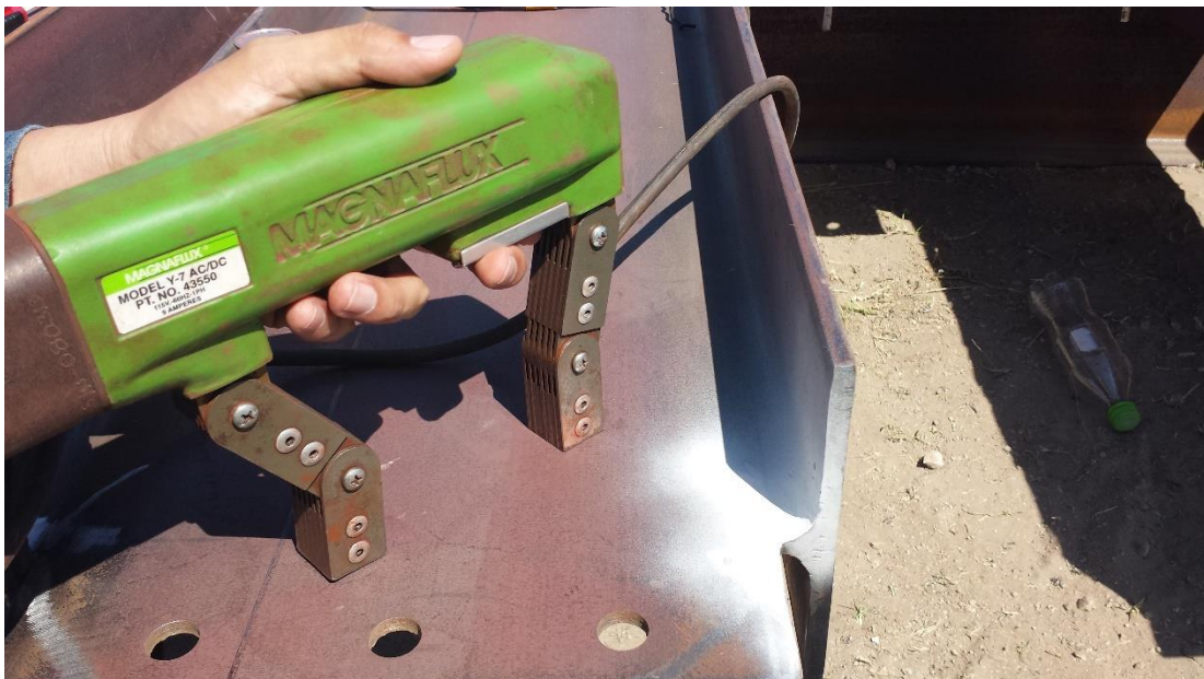
Figura 13. Ejemplo de uso de la técnica de las partículas magnéticas.
