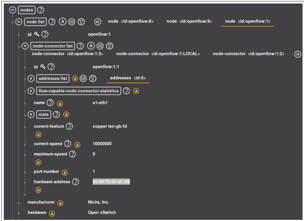
Figura 24: Descubriendo la dirección mac del switch OpenFlow s1
