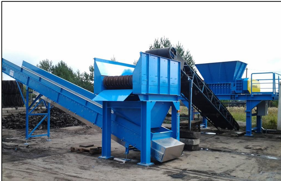
Ejemplo de cinta transportadora con inclinación
