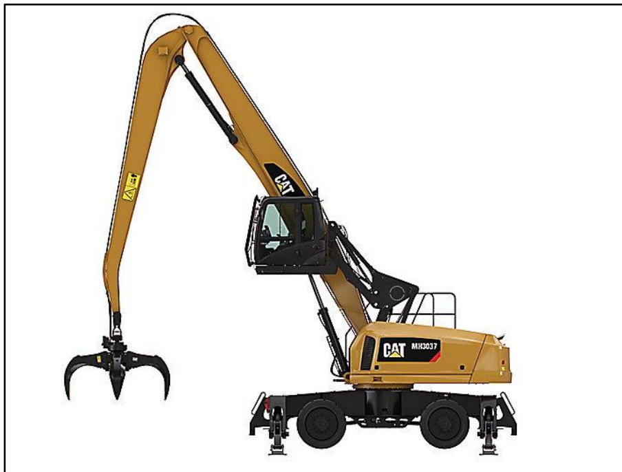
Excavadora manipuladora de materiales con pulpo de garras.
