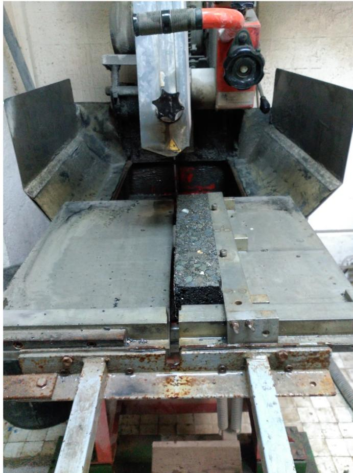
*Figura 45 Serrado de la probeta (Elaboración propia)*
