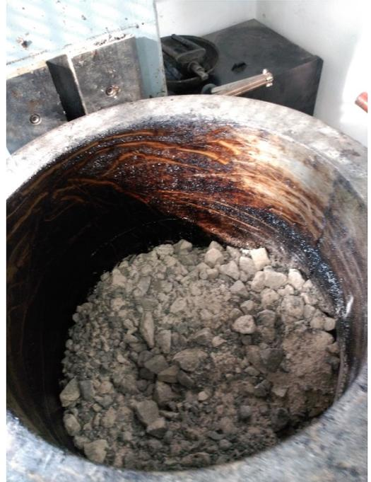
Figura 34 Recipiente cilíndrico de la amasadora (Elaboración propia)
