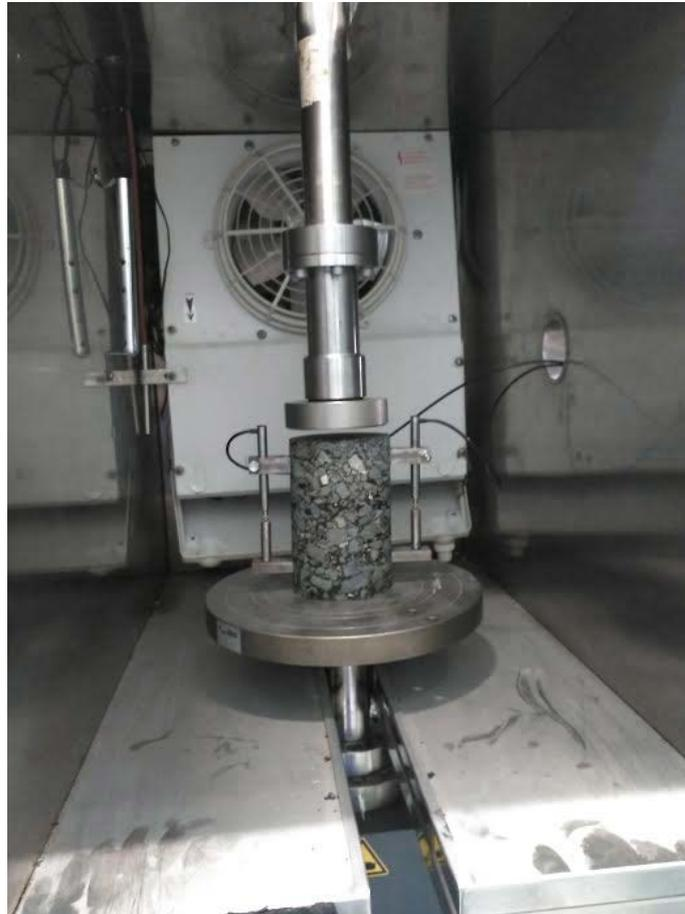
*Figura 54 Montaje del LVDT*
