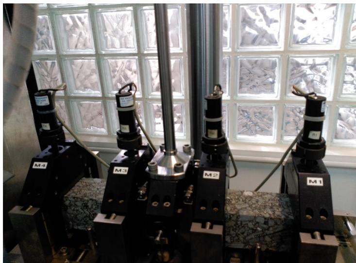
Figura 43 Mordazas de la máquina de ensayo (Elaboración propia)
