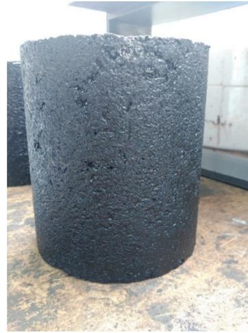
*Figura 40 Probeta recién extraída2
