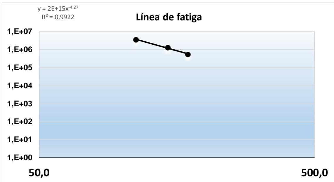
Tabla 2 Línea de fatiga 150,739 microdeformaciones al millón de ciclos
