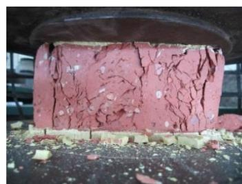
Fig 5.11: Ensayo de compresión realizado en la probeta 1.
