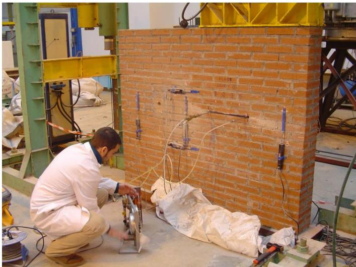
Fig 5.15: Ensayo de gato plano simple en un muro de ladrillo en el Laboratorio de Estructuras de la UC (Colaboración GTED - AIDICO)
