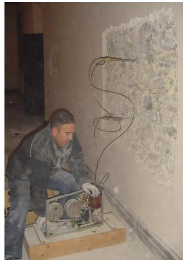
Fig 5.16: Ensayo de gato plano doble en el Seminario Mayor de Comillas, Cantabria (Colaboración GTED - AIDICO)
