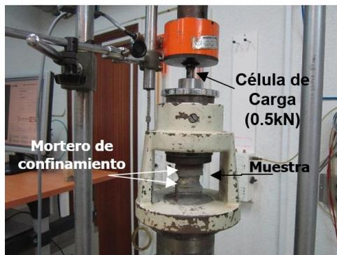
Fig. 5.7. Desarrollo del ensayo a compresión de la muestra de mortero confinado.
