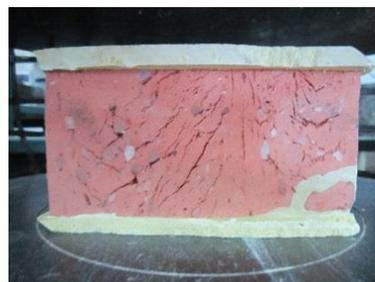
Fig 5.9: Refrentado de las muestras de ladrillo.
