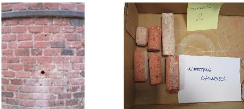
Fig. 5.12: Perforación 2 realizada (izq.) y detalle de las muestras obtenidas (dcha.).
