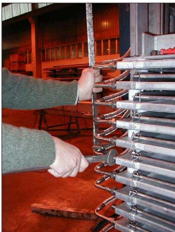
El extremo curvo de la manguera, que va al manguito de la placa, se sujeta por el codo con una llave inglesa. Éste debe sujetarse firmemente y girado 5° ó 10°, en sentido contrario al de apriete, respecto a su posición definitiva, en la que se posicionará él solo una vez eliminada la tensión que le supone la llave.
