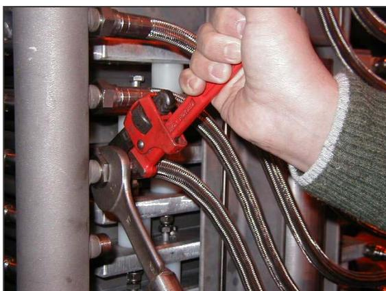
El extremo de la manguera que va contra el colector, se sujeta por la zona rígida con la llave de tubos, apretándose la tuerca con la llave plana correspondiente, no dejando girar el ovalillo para asegurar así un buen apriete.
