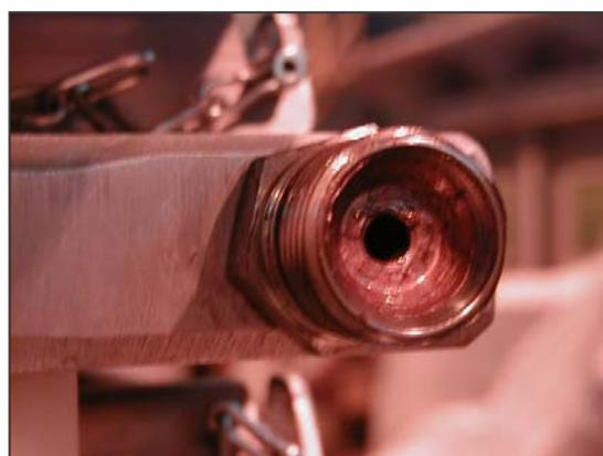
A continuación, se roscan a mano las tuercas locas de la manguera hasta su aproximación, un extremo al manguito de la placa y el extremo opuesto al colector.
