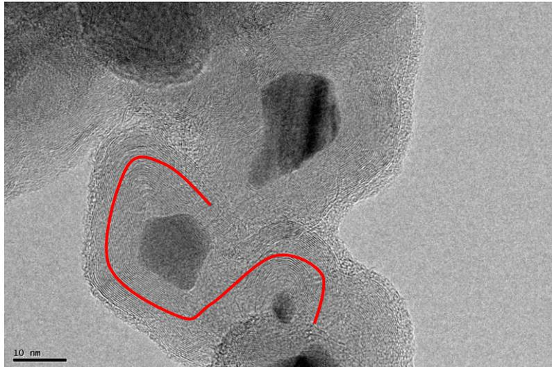
**Figura 5.3.2.4.** Los MWCNTs se doblaban en torno al líquido iónico entrante formando núcleos de Emim rodeados por capas de nanotubos. En la foto A) se muestran una imagen y su ampliación. En la B), la línea roja muestra el recorrido de uno de los nanotubos en torno al Emim.
