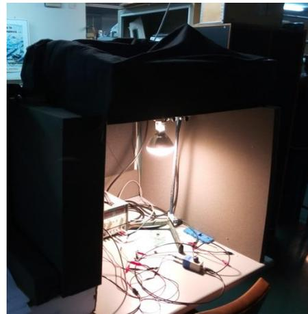
La célula que se va a utilizar en este trabajo es un fotodiodo de Si de la serie S1337 de la casa *Hamamatsu*, concretamente el modelo 1010BR. La hoja de características de este dispositivo se encuentra en el anexo III.
