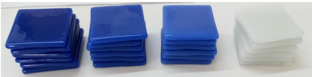
**Figura 3.1** Fotografía de cuatro series de pastillas coloreadas en volumen, con diferentes concentraciones de pigmento azul.
