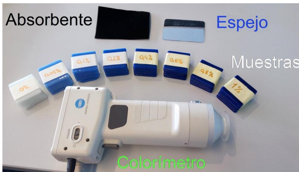
**Figura 3.3.** Fotografía de las pastillas con su porcentaje de colorante azul escrito, espejo, fieltro negro y colorímetro empleados para la toma de medidas realizada en este apartado.
