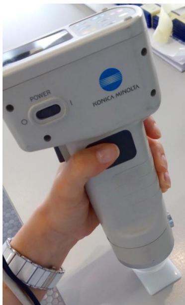
**Figura 2.7.** Fotografía del colorímetro Konica Minolta CR-400 empleado para este trabajo.
