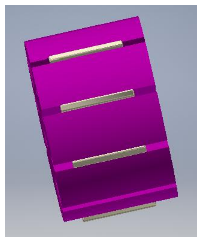
Figura 5. 5 Figura del rotor con los imanes colocados en su posición final. Elaboración propia.
