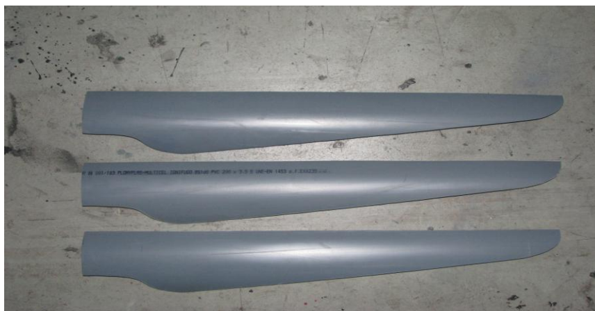
Figura 5. 9 Palas obtenidas del tubo de PVC [25]
