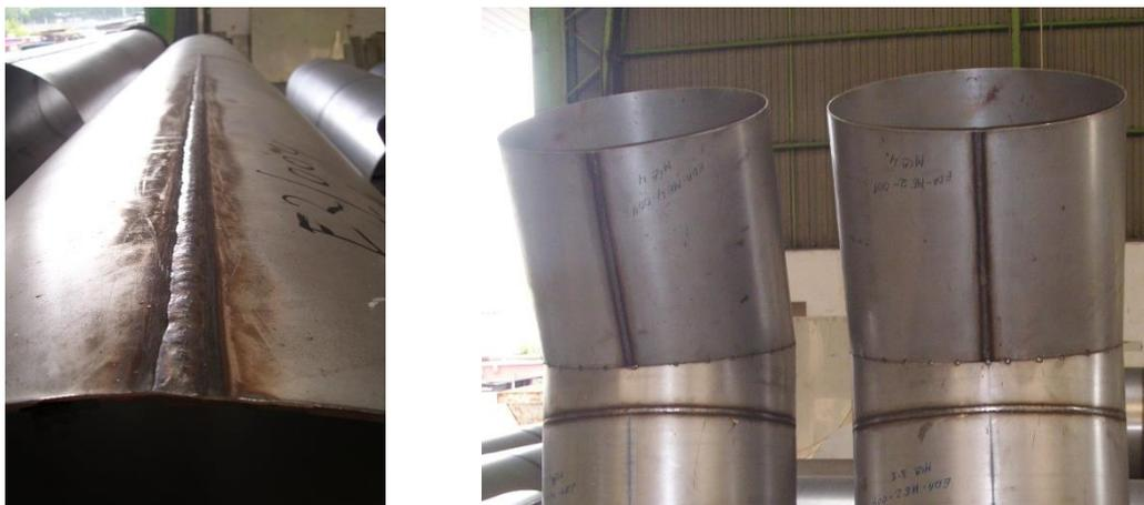
Figura 26. Soldadura MIG (izqda.) y tubos conformados con chapa de acero Dúplex (dcha.).
