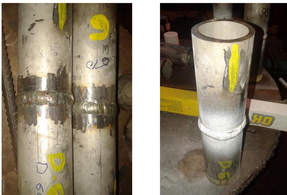
Figura 22. Probetas sometidas a inspección visual (izqda.) y a inspección magnética (dcha.)
