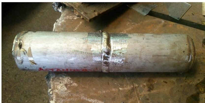
*Figura 21. Cupón de ensayo.*
