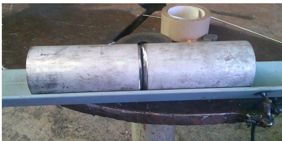
Figura 19. Preparación de bordes del cupón de ensayo: unión a tope en V a 60°.
