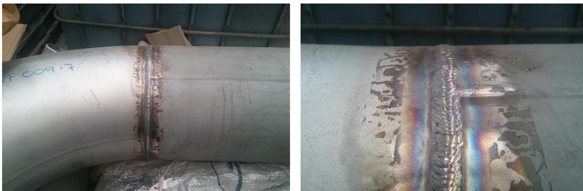
Figura 25. Tubo de SuperDúplex soldado con proceso TIG.
