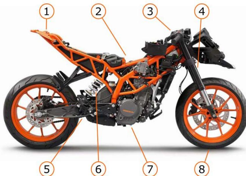
**Fig. 3-1 1.Subchasis 2.Chasis 3.Sistema de dirección 4.Horquilla suspensión 5.Basculante
