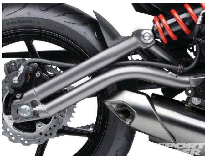
**Fig. 3-12 Basculante tubular de doble brazo**
