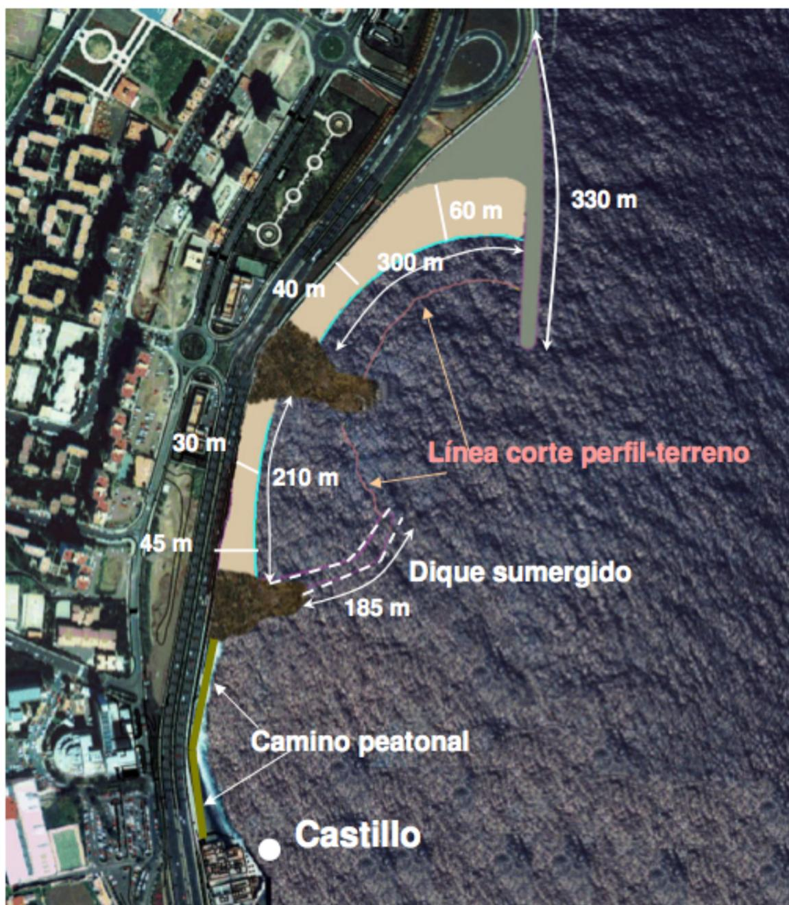
Figura 6. 15 Variante II Creación de una playa compartimentada
