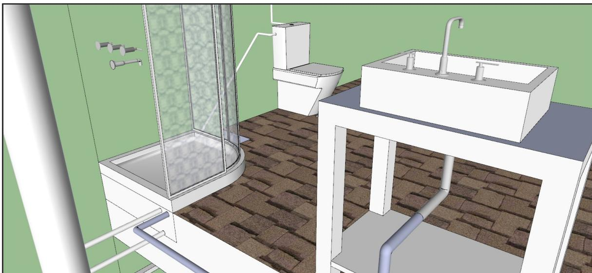
Ilustración 4.-Detalle sistema de reutilización
