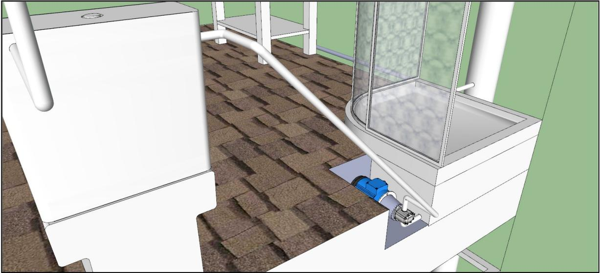
**Ilustración 17.-Detalle sistema de reutilización**
