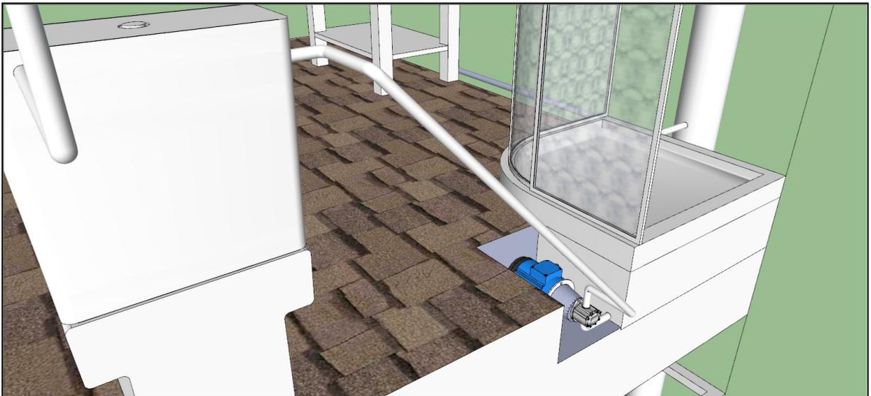
**Ilustración 3.-Detalle sistema de reutilización**
