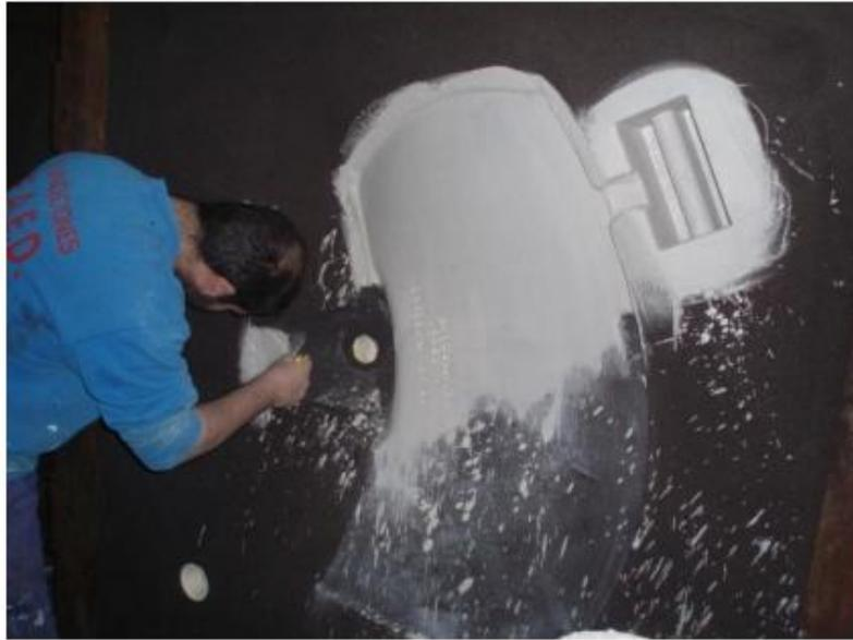
**Figura 10 - Pintado del molde después de retirar el modelo**
