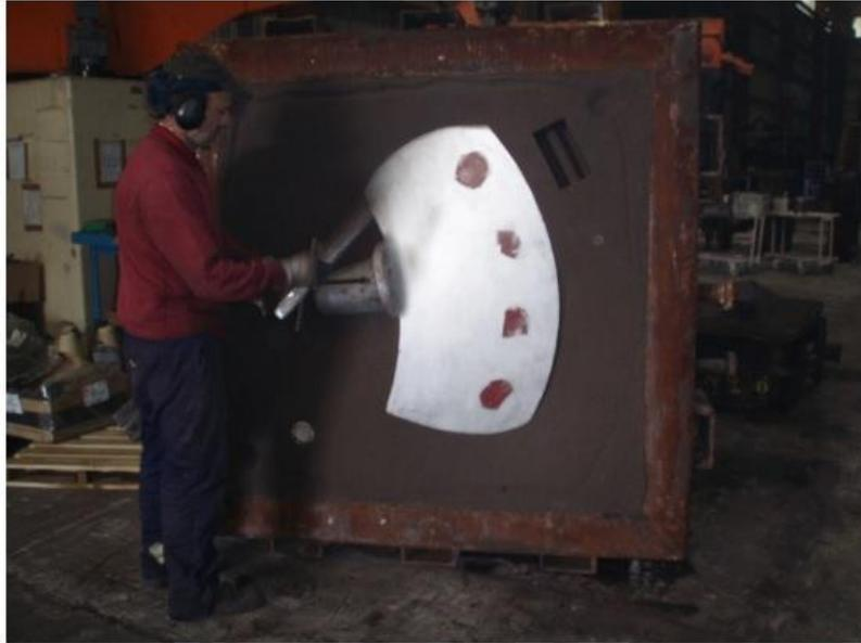
**Figura 8 - Moldeo con modelo de madera**
