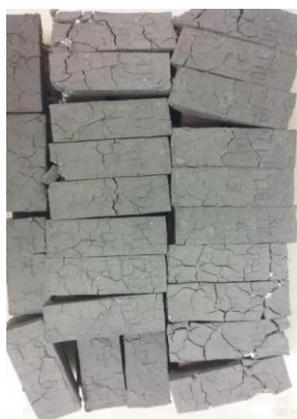
Figura 20. Expansión en los ladrillos de ceniza activados con las rocas de CaO
