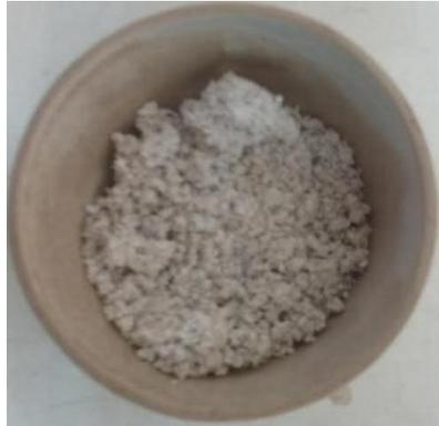
*Figura 12. Activador alcalino residual sólido:  $\text{Si-CaCO}_3\text{-Ca(OH)}_2$*
