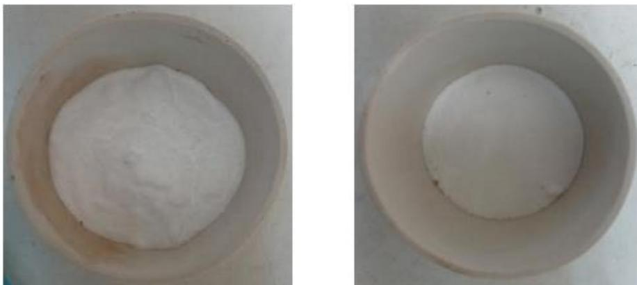
Figura 11. Activadores alcalinos residuales sólidos:  $\text{Na}_2\text{CO}_3 > 90\%$  y  $\text{NaHCO}_3 > 90\%$
