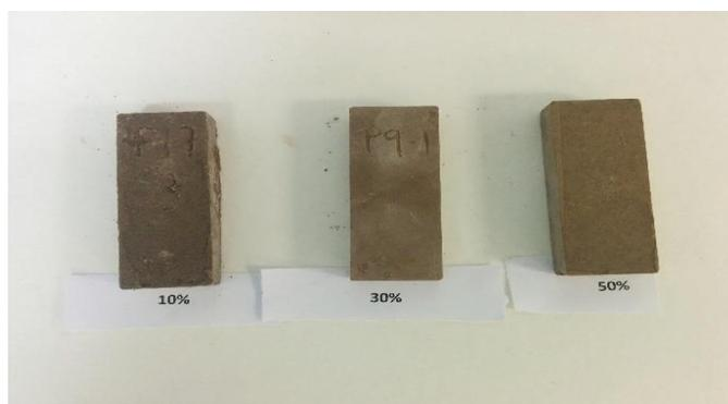
Figura 16. Geopolímeros activados sustituyendo el  $\text{Na}_2\text{SiO}_3$  por lechadas de Ca y Mg
