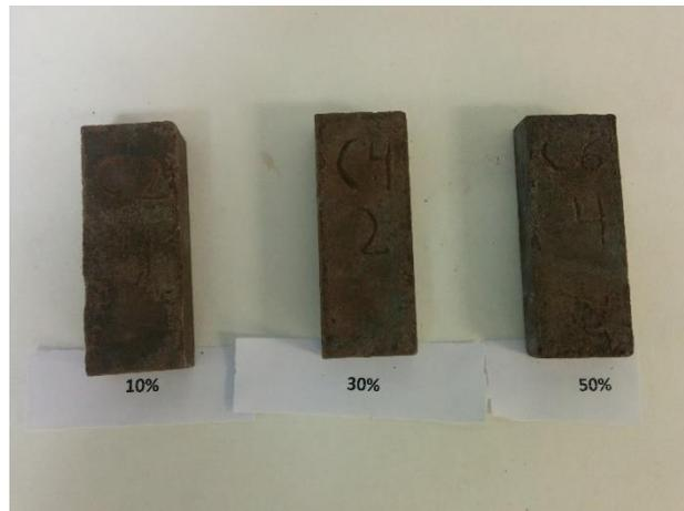
Figura 18. Geopolímeros activados sustituyendo el  $\text{Na}_2\text{SiO}_3$  por carbonato sódico
