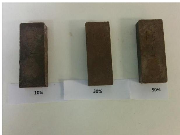
Figura 19. Geopolímeros activados sustituyendo el  $\text{Na}_2\text{SiO}_3$  por bicarbonato sódico
