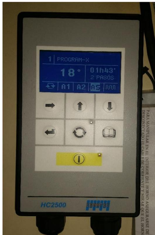
*Figura 2.2.2: Controlador PID de temperatura.*
