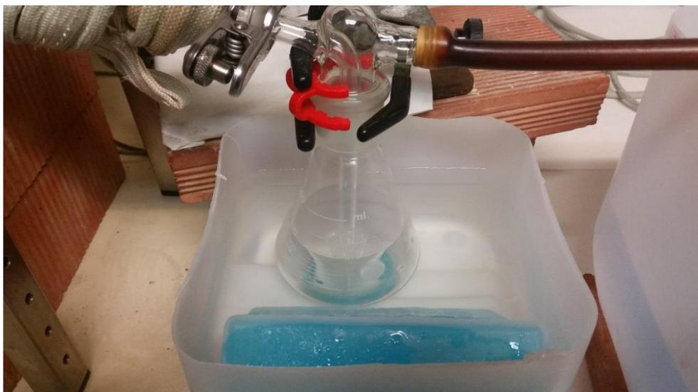
*Figura 3.2.4: Erlenmeyer refrigerado para la recogida de la fracción líquida.*
