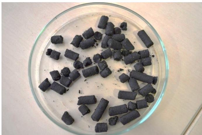
*Figura 1.3.2: Pellets obtenidos a partir de lodos.*
