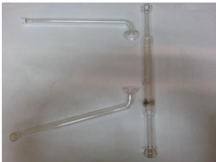
**Figura 3.2.1:** Conjunto de reactor y codos.
