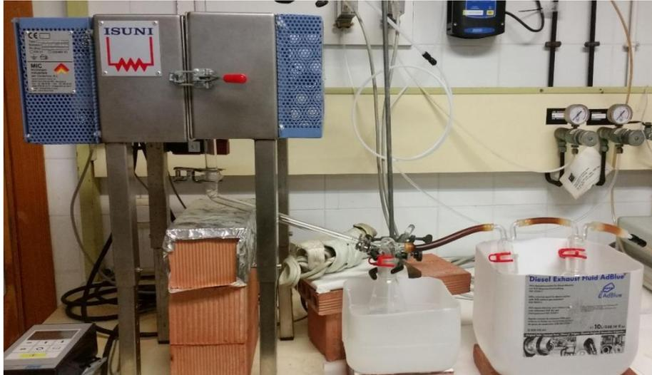
*Figura 2.2.1: Instalación para pirólisis.*
