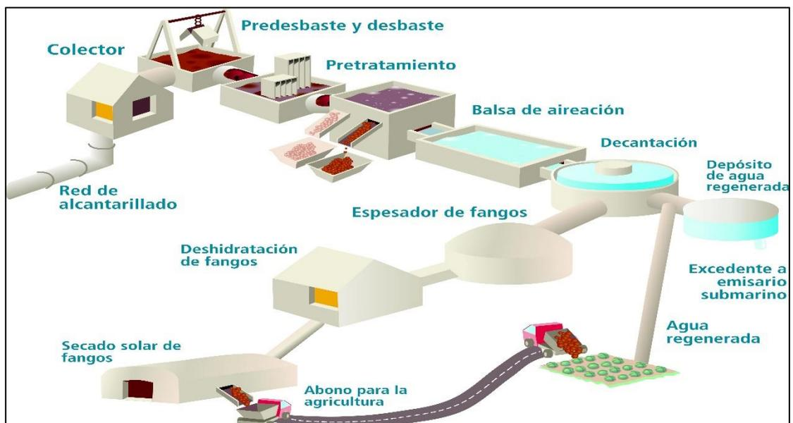
Figura 1.1.1.1: Ejemplo de Estación Depuradora De Aguas Residuales (EDAR).
