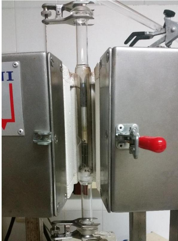
**Figura 2.4.1:** Reactor colocado en el interior del horno.
