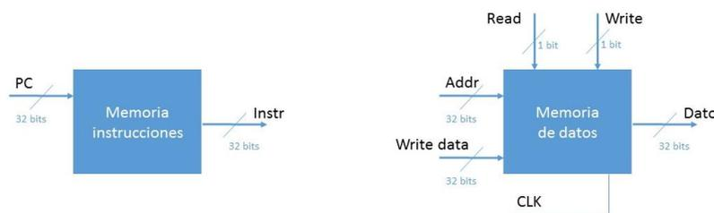
Figura 3.1.6 Esquema de conexiones de la memoria de instrucciones (izqu.) y de datos (drch.).
