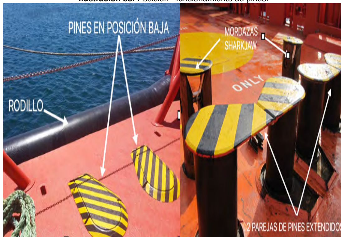
Ilustración 88: Posición - funcionamiento de pines.
