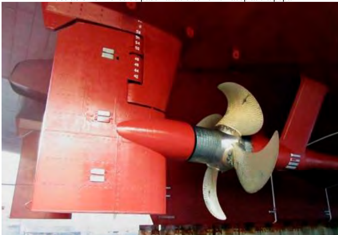
Ilustración 9: Hélice de paso variable con timón acoplado a popa.
