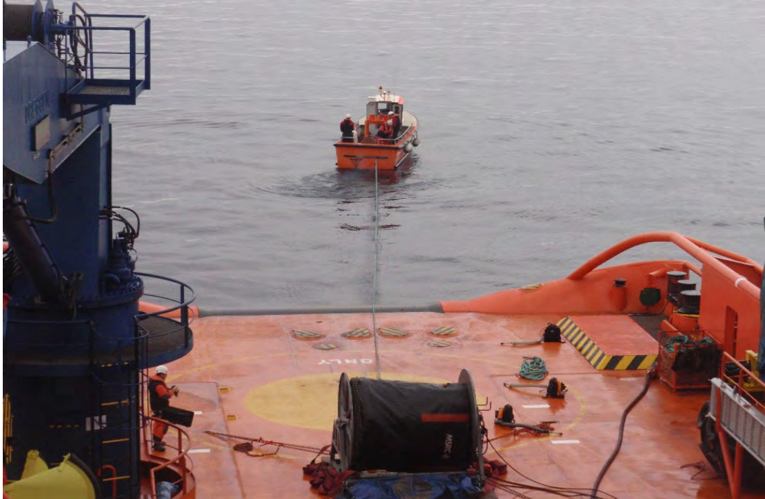
Ilustración 70: Embarcación auxiliar hace firme el chicote de la barrera.
