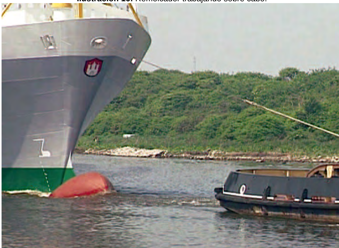
Ilustración 16: Remolcador trabajando sobre cabo.
