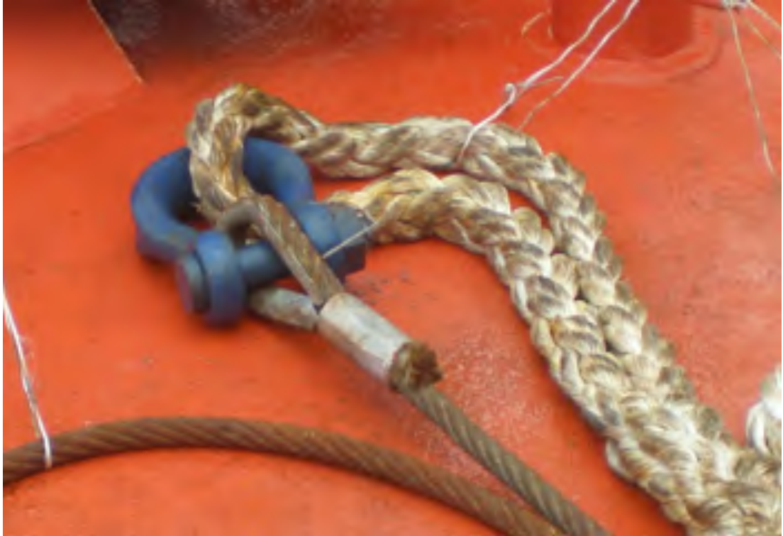
Ilustración 97: Conexión entre pennant y dyneema con grillete.
