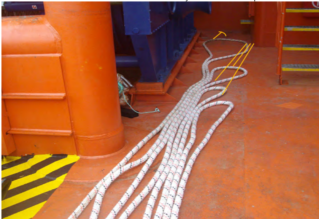
Ilustración 95: Colocación estachas y cables tren remolque.
