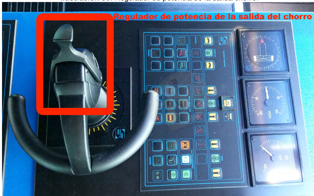
Ilustración 60: Regulador de potencia de la salida chorro.
