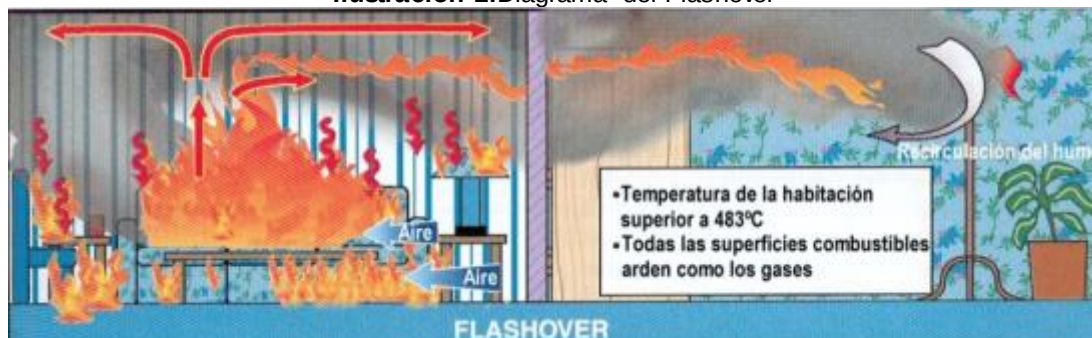
Ilustración 2: Diagrama del Flashover
