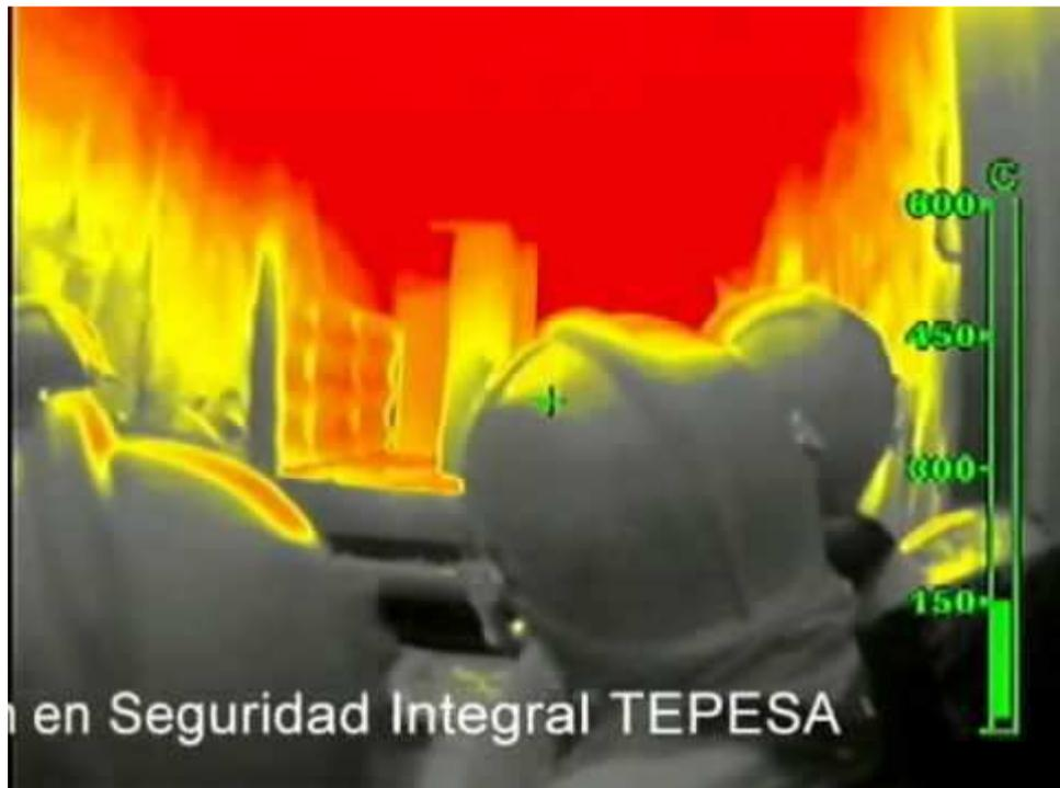
**Fotografía 15:** Situación de Flashover visto con cámara térmica
