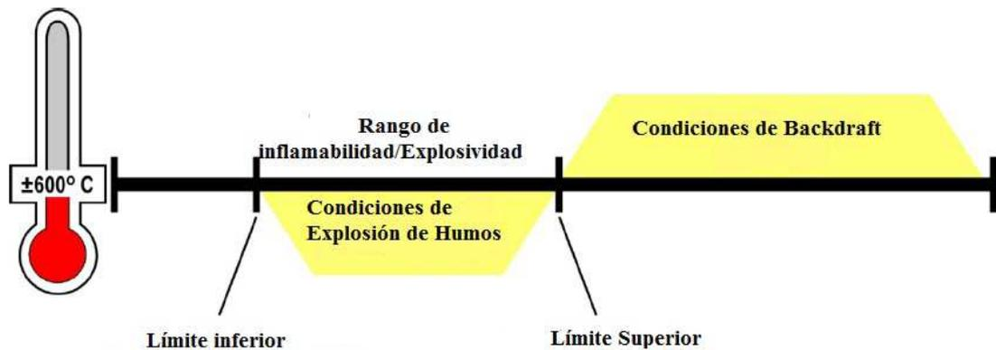
**Foto 21:** Condiciones de Explosión de Humos y Backdraft
