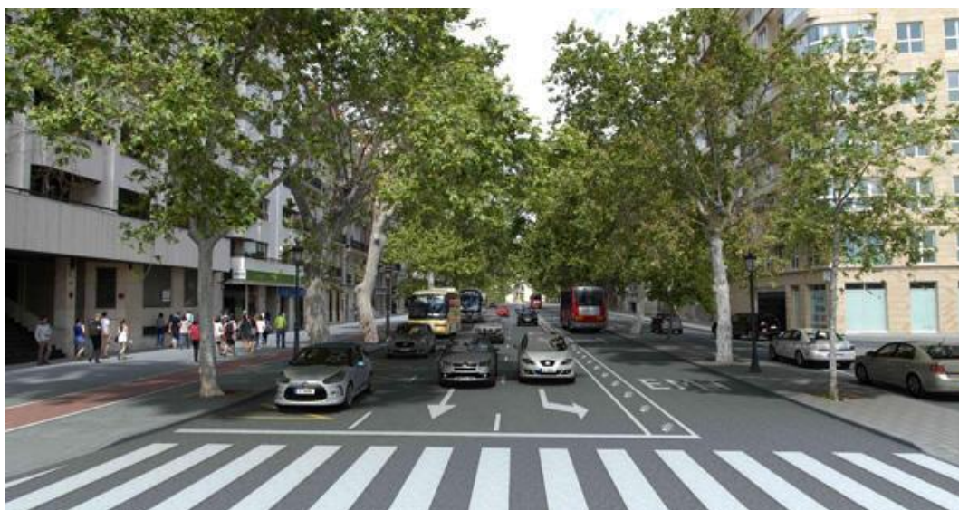
Ilustración 5: Carril bus en sentido contrario al de la circulación
