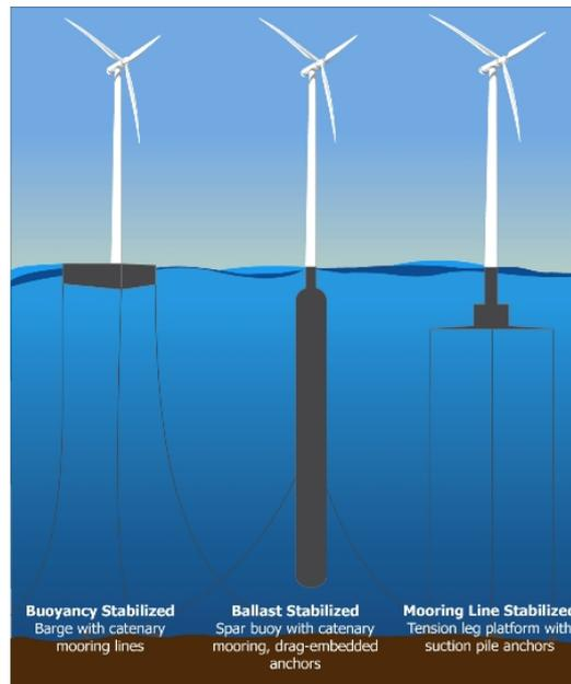
Figura 2.19: Ejemplo de los tres métodos básicos de estabilización de plataformas flotantes. [Fuente: NREL]
