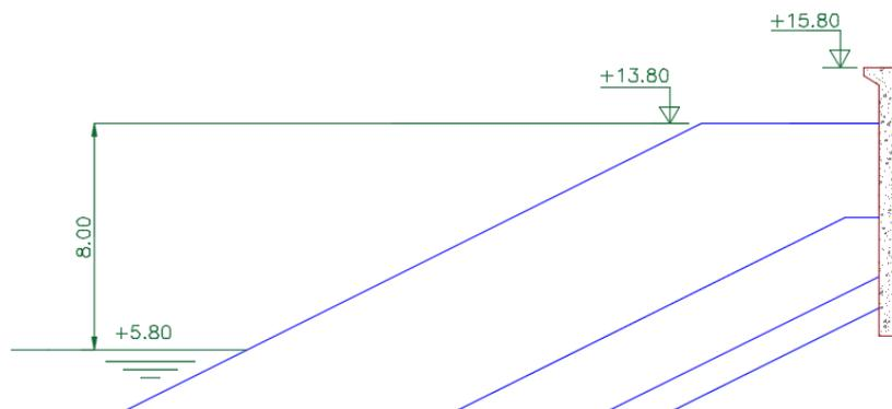
Figura 31: Cota de la berma superior y coronación del espaldón.
