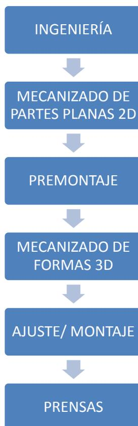
**Figura 2: diagrama del proceso de producción básico por áreas de trabajo.**
