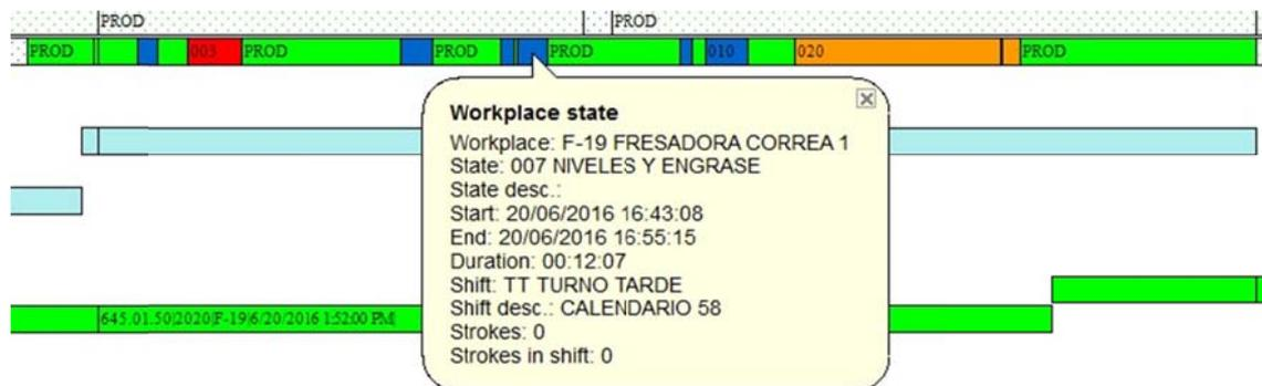
**Figura 36: Diagrama de Gantt: especificaciones de la parada “Niveles y engrase”.**
