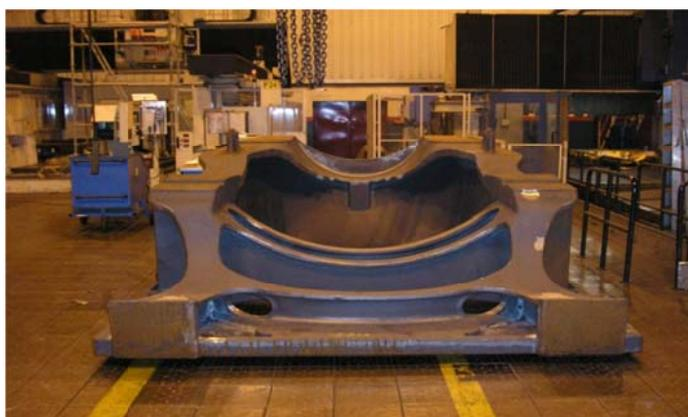
**Figura 44: imagen de una caja de rotor de aerogeneradores para FILGUERA MELT.**
