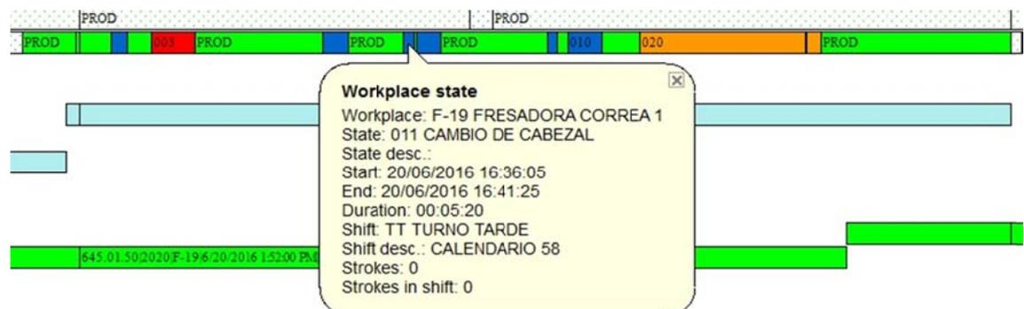
**Figura 35: Diagrama de Gantt: especificaciones de la parada “Cambio de cabezal”.**
