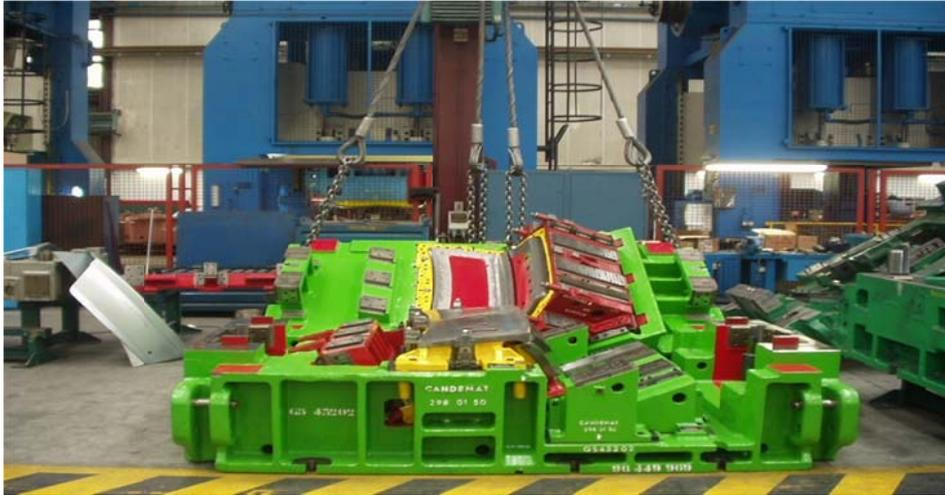
**Figura 41: Troquel de una tapa maleta exterior para PSA.**
