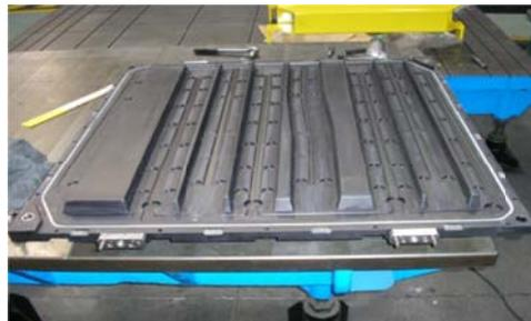
**Figura 42: Molde RTM (inyección de resina ) para SONACA AEROESPACIAL**
