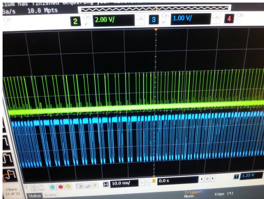
Figura 37 - Prueba sobre el osciloscopio del sensor de ultrasonidos midiendo una distancia de alrededor de 20 cm. Señal de “Trigger” en verde y “Echo” en azul.
