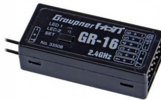
Figura 8 - Receptor de radiofrecuencia Graupner GR-16
