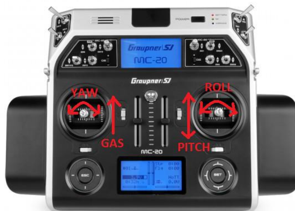
Figura 7 - Relación de controles del mando y ángulos de navegación
