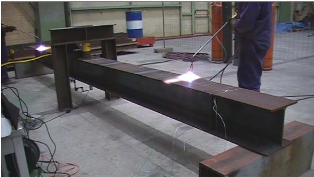
*Figura 1.1 Operario aplicando un tratamiento de enderezado por llama sobre un perfil estructural metálico*
