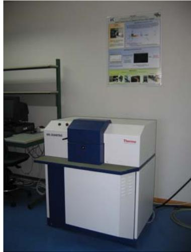
*Figura 3.21 Maquinaria THERMO-ARL QUANTRIS empleada en el análisis químico por espectrometría de emisión óptica por chispa*
