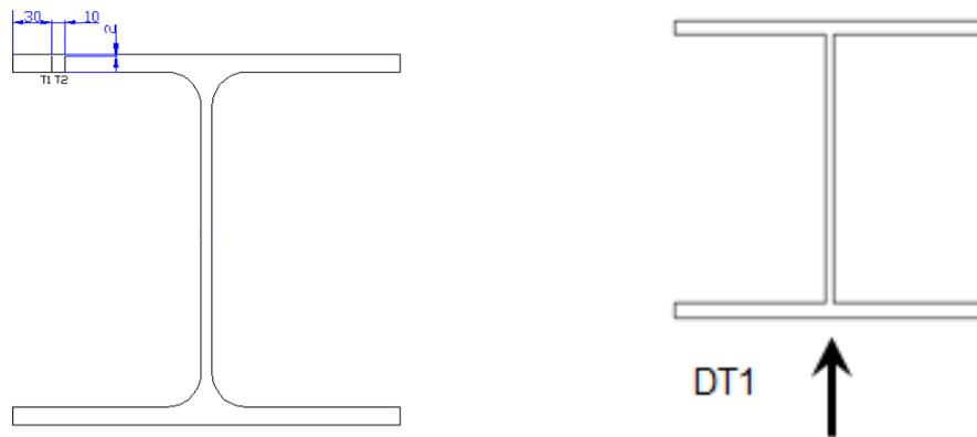
**Figura 6.15** Esquema de colocación de la instrumentación en los ensayos de perfiles de grandes dimensiones. a) Termopares b) Comparador vertical
