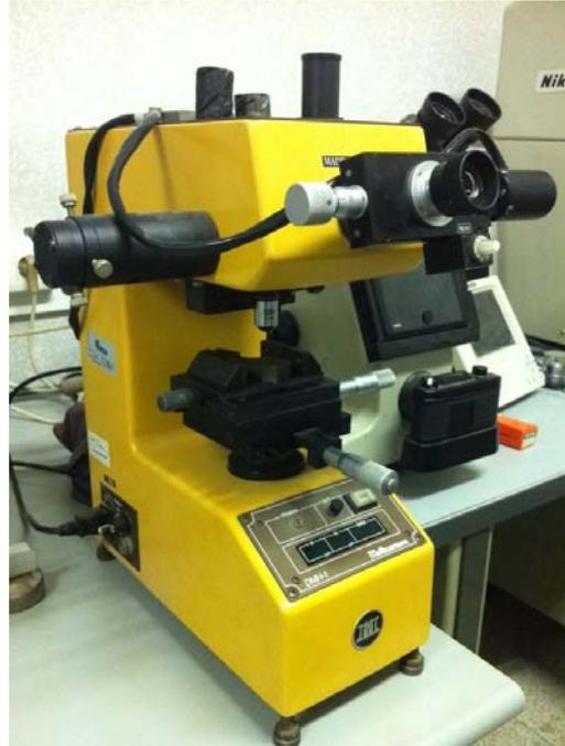
*Figura 3.22 Microdurómetro Vickers Matshusawa*
