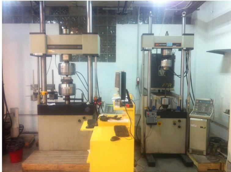
*Figura 3.27 Imagen de las máquinas INSTRON empleadas en los ensayos de tracción; a la derecha el modelo 8501 (100 kN) y a la izquierda el 8803 (250 kN)*
