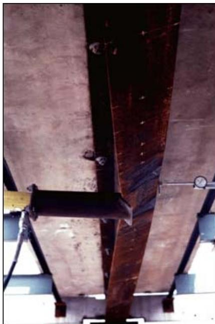
*Figura 2.5 Daño tipo T en una viga de un puente. Un ala está fija por la sujeción al puente, provocando que la otra ala que está libre así como el alma sufran deformaciones plásticas. El daño ha sido provocado por la aplicación de una fuerza con un gato como parte de un experimento. [1]*
