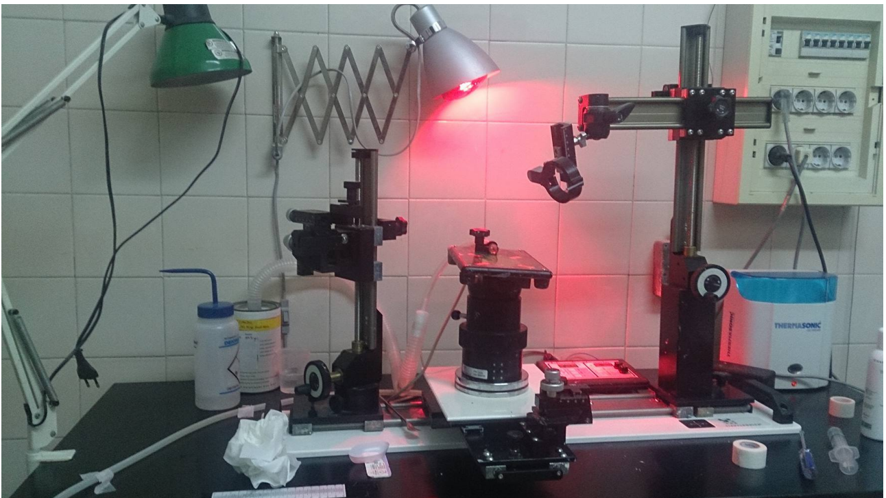
Figura 9. Fotografía del brazo articulado donde se coloca la sonda y de la placa térmica donde se sitúa al ratón para realizar la ecocardiografía.
