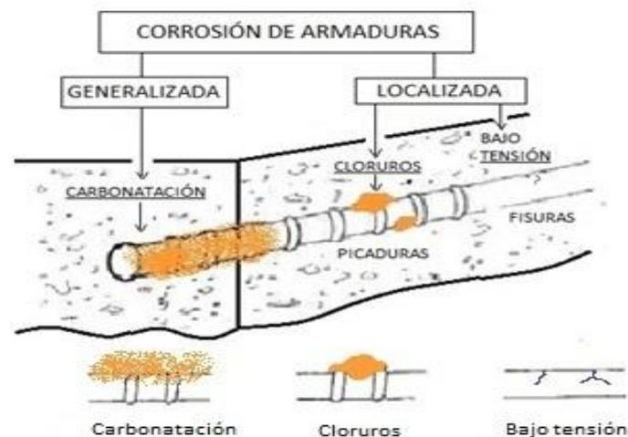
**Figura 15.** Tipos de corrosión en las armaduras de hormigón.
