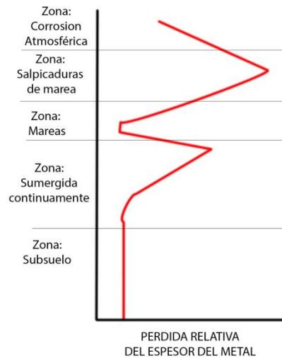
**Figura 16.** Reducción relativa del espesor de una barra de acero según la zona de inmersión a la que se encuentre en agua de mar [93].
