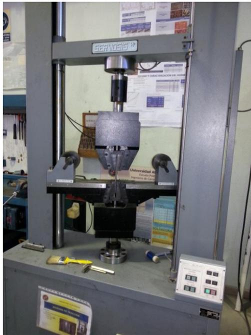
**Figura 51.** Máquina universal de ensayos de tracción SERVOSIS (ME 402 E).
