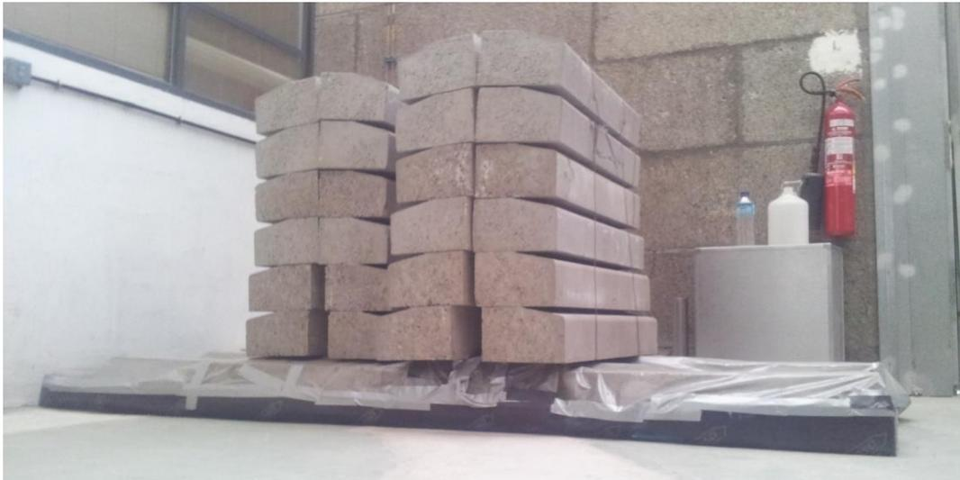
**Figura 43.** Montaje de las vigas una vez cargadas.
