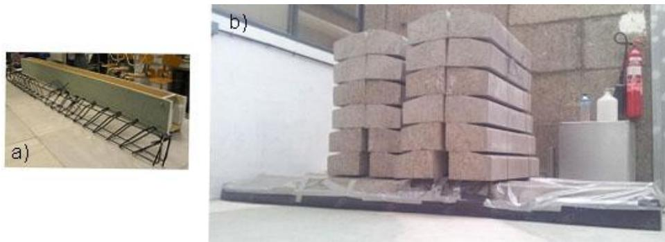
**Figura 79.** Montaje de las vigas. a) Armadura de las vigas. b) Disposición de las vigas en taller.
