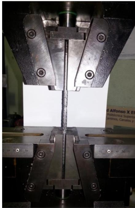
**Figura 52.** Muestra una vez terminado el ensayo de tracción.
