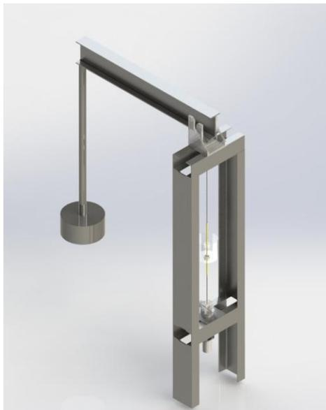
**Figura 35.** Esquema del montaje en la máquina de fluencia.
