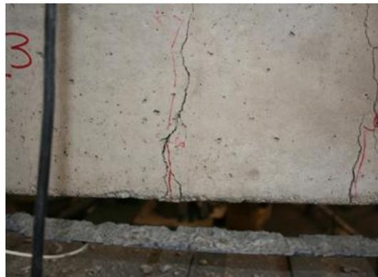
**Figura 3.** Hormigón agrietado por la corrosión de las armaduras.
