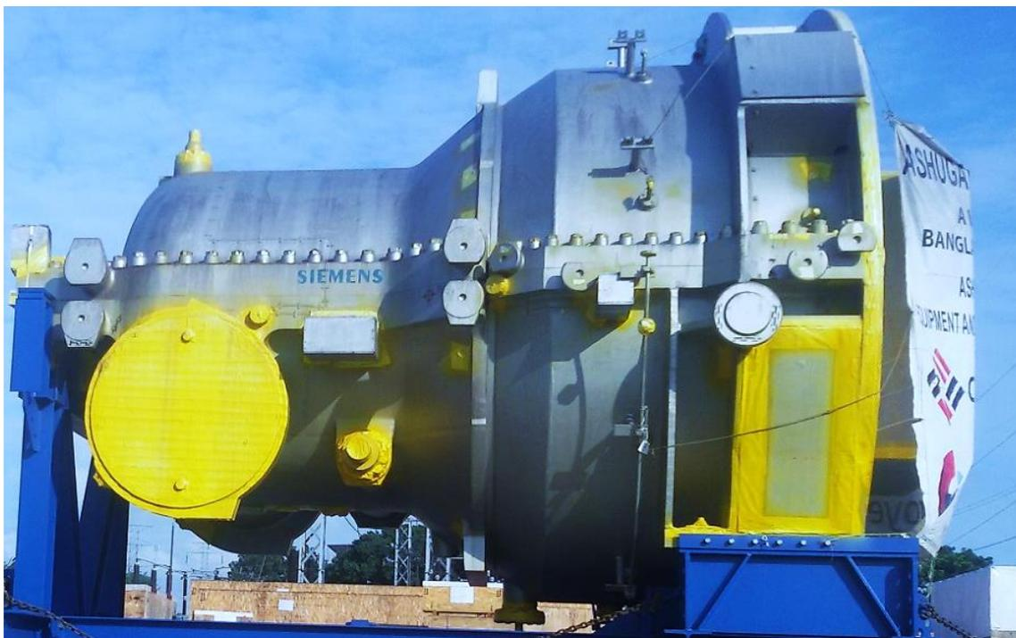
Ilustración 47 - Turbina de baja presión. Fuente: Marmedsa Proyectos.
