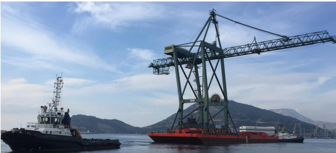
Ilustración 64 - Remolque de gabarra para el transporte de una grúa en Cartagena. Fuente: Marmedsa proyectos.
