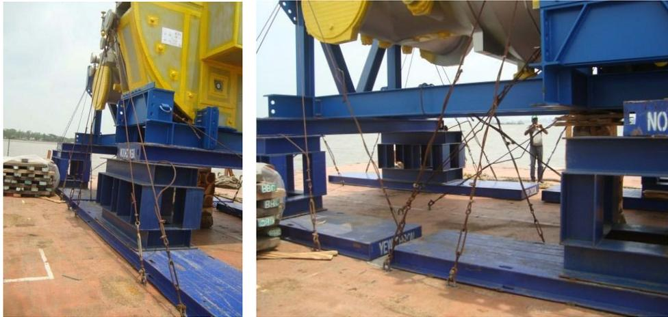
Ilustración 79 - Fotografía general de la trinca de la turbina. Fuente: Marmedsa proyectos.
