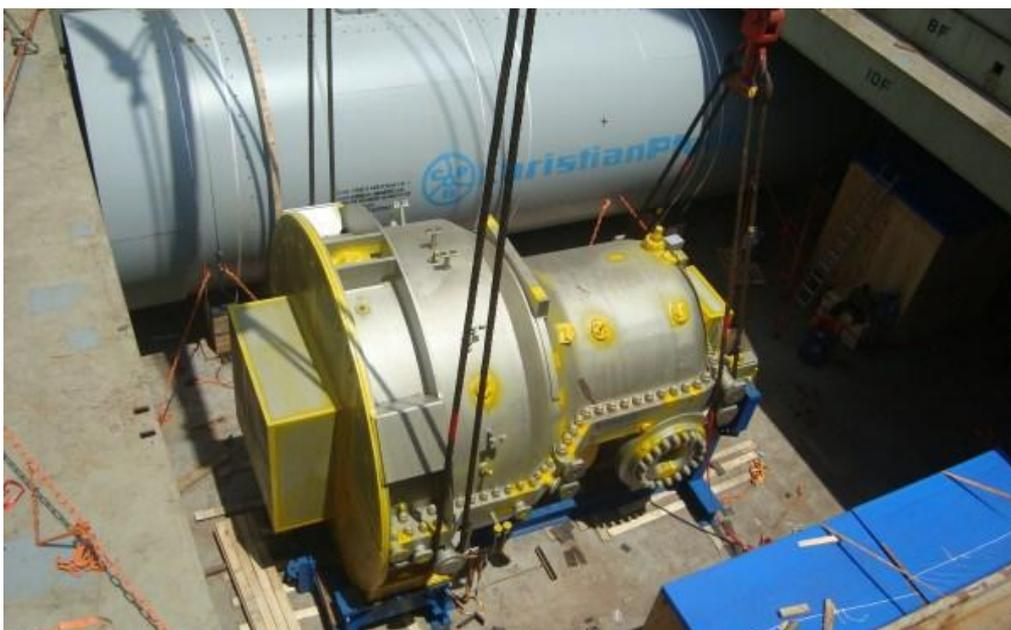
Ilustración 68 - Turbina cargada en bodega. Fuente: Marmedsa proyectos.
