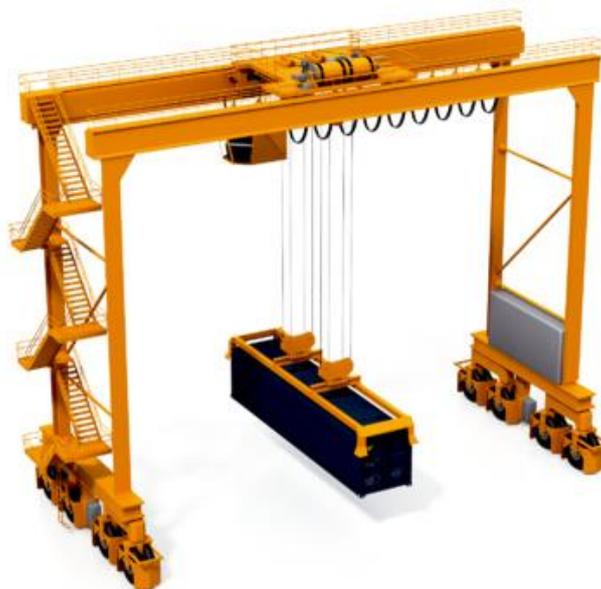
Ilustración 32 - Grúa RTG cargando contenedor. Fuente: Marmedsa Proyectos.
