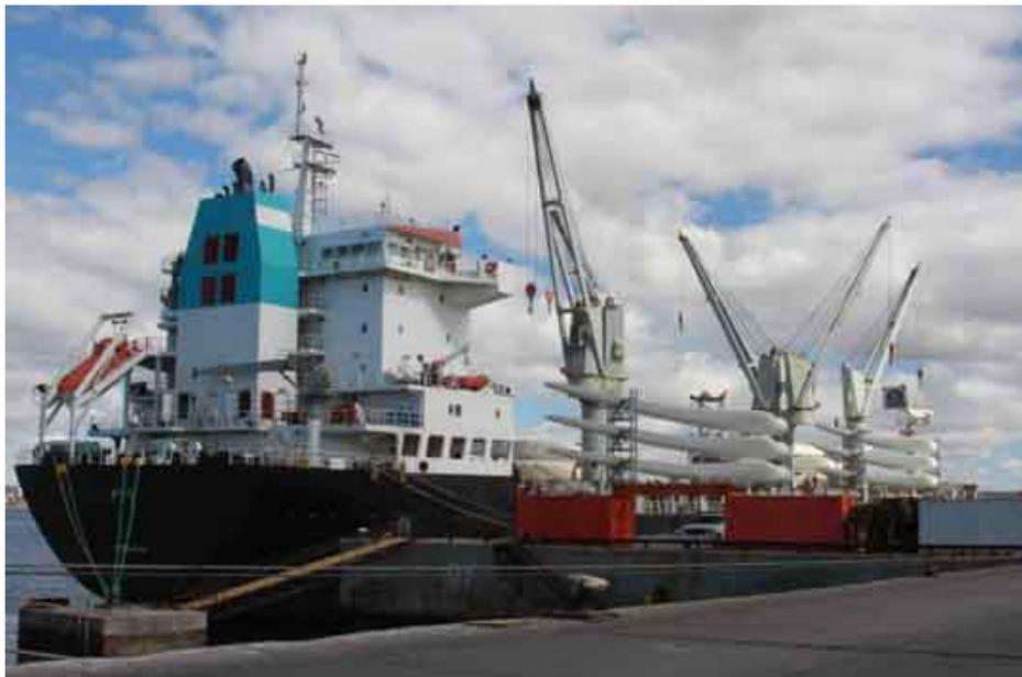
Ilustración 27 - Palas eólicas sobre cubierta. Fuente: Marmedsa Proyectos.
