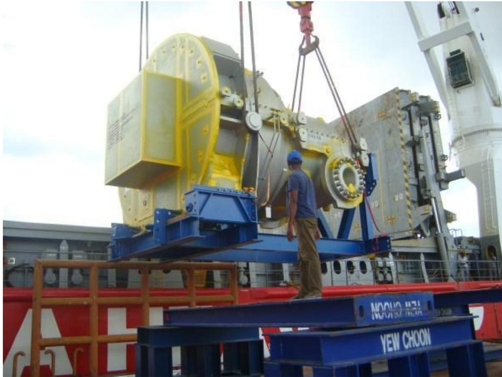
Ilustración 74 - Descarga de la turbina desde bodega de buque hasta gabarra. Fuente: Marmedsa proyectos.
