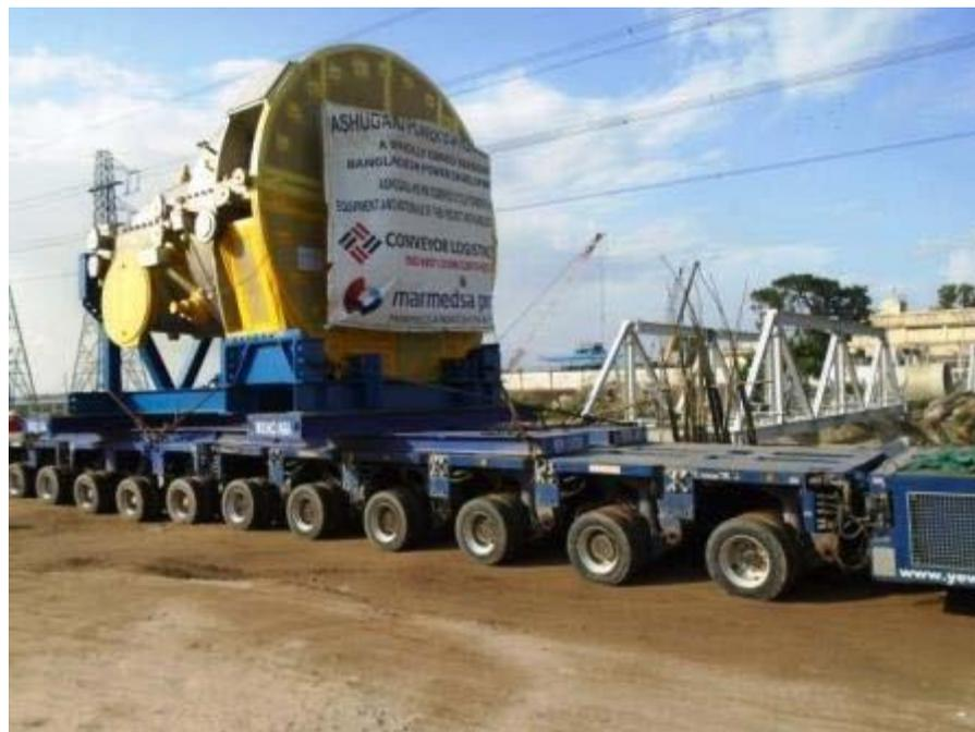
Ilustración 84 - Transporte terrestre de la turbina. Fuente: Marmedsa proyectos.
