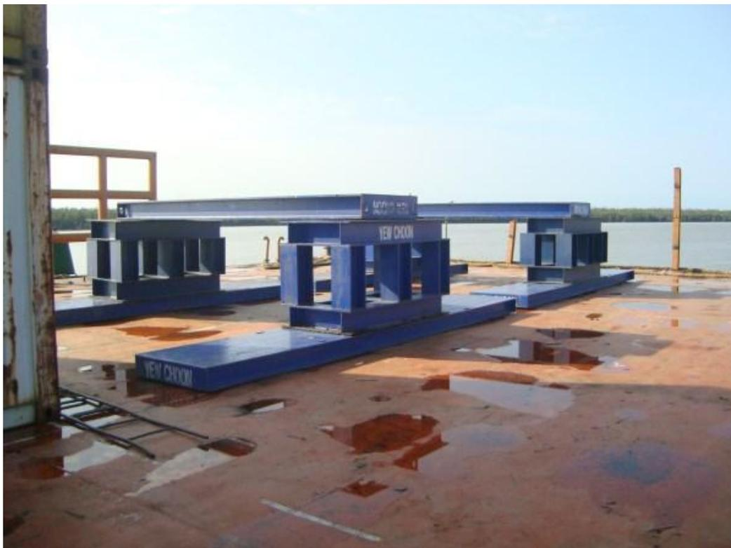
Ilustración 72 - Estructura soldada sobre gabarra para el posicionado de la turbina. Fuente: Marmedsa proyectos.
