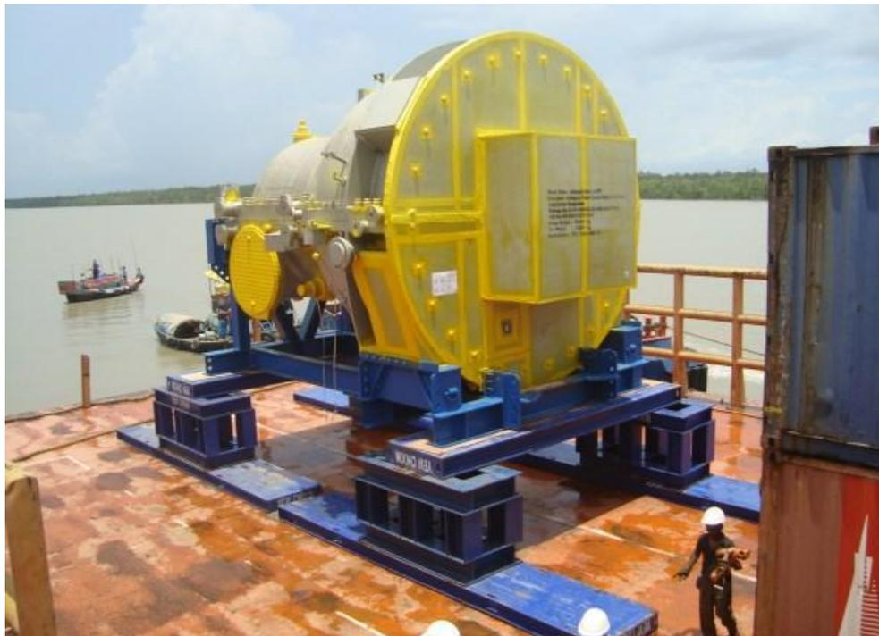
Ilustración 76 - Turbina posicionada sobre gabarra. Fuente: Marmedsa proyectos.
