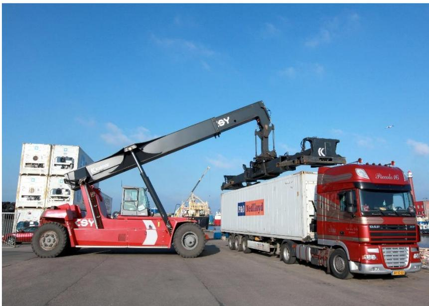
Ilustración 26 - Reach Stacker descargando contenedor desde camión. Fuente: Wikipedia.
