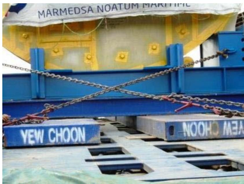
Ilustración 83 - Turbina trincada mediante cadenas sobre el SPMT. Fuente: Marmedsa proyectos.
