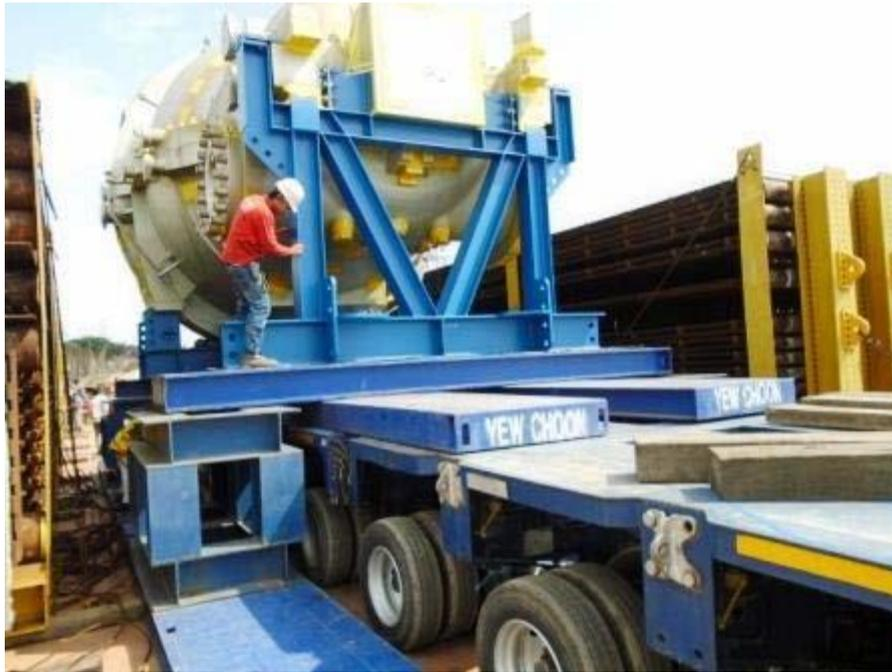
Ilustración 82 - Posicionado del SOMT debajo de la turbina, para proceder a su carga.
