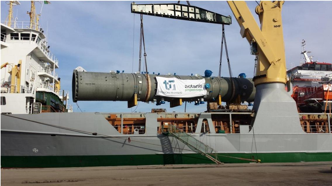
Ilustración 31 - Carga convencional mediante grúas de buque. Fuente: Actanis Project Cargo.
