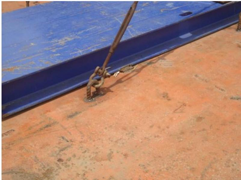
**Ilustración 78 - Foto ejemplificada de sujeción mediante D-ring. Fuente: Marmedsa proyectos.**
