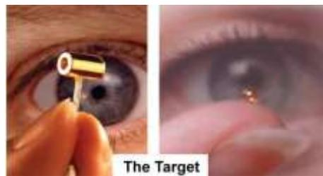
Figura 30 - Cápsula de DT para el confinamiento inercial. FUENTE: <http://francis.naukas.com/2012/01/09/la-ignicion-de-la-fusion-por-confinamiento-inercial-queda-fuera-de-la-agenda-del-nif-para-2012/>
