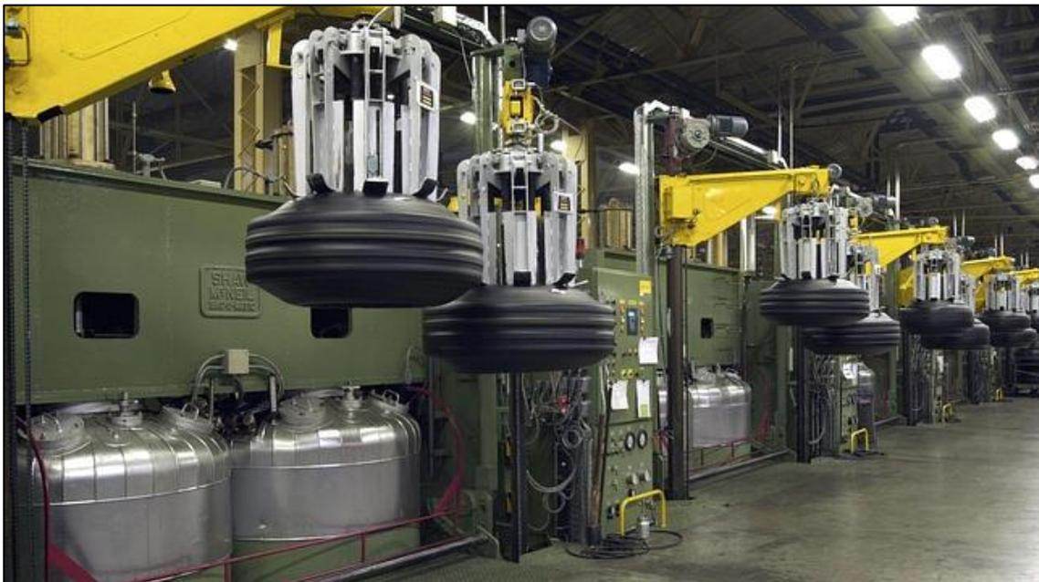
Ilustración 7 - Prensas de vulcanizado. Fuente: Bridgestone
