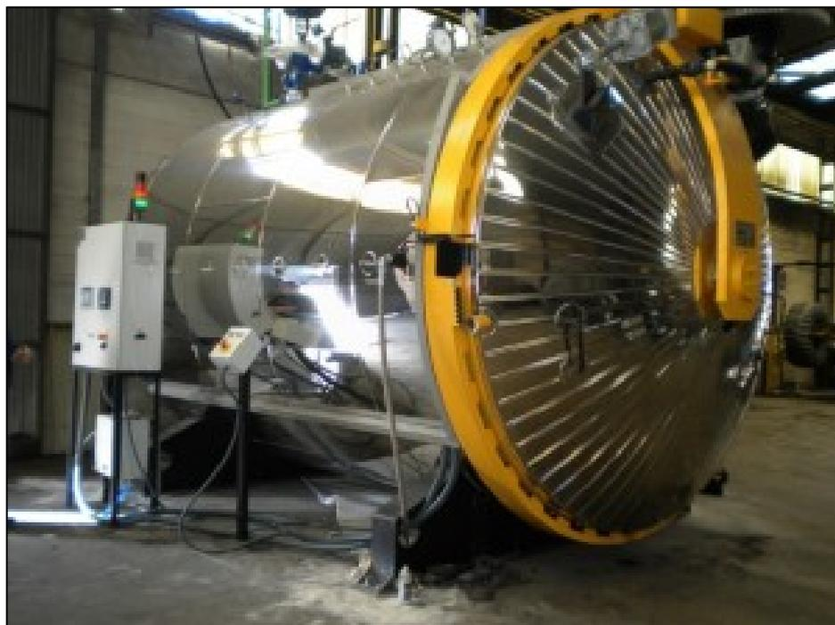
Ilustración 9 - Autoclave. (Fuente: Bridgestone).
