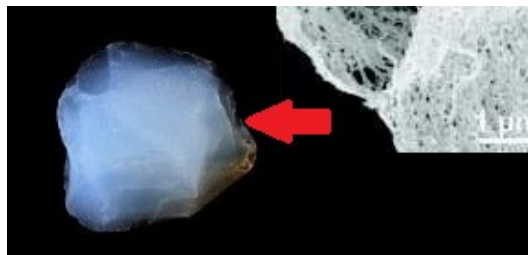
Figura 124: Estructura de una matriz de aerogel de silicio (Si). A la derecha se observa la estructura vista desde un microscopio.
