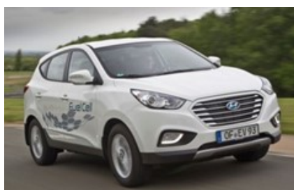
Figura 27: Hyundai ix35 FCEV, primer vehículo de pila de combustible comercializado.
