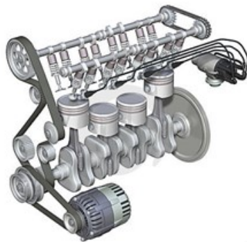
Figura 39: Modelo en Auto CAD sobre el interior de un motor de combustión interna de ignición por chispa.
