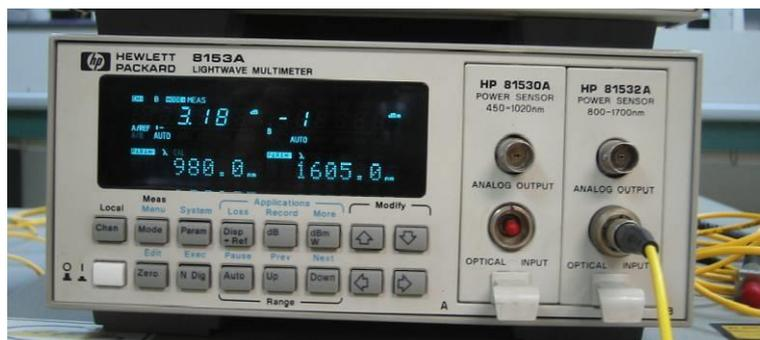
Figura 3.4. Medidor de potencia HP8153A.
