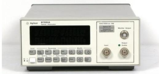
Figura 3.7. Fotografía del atenuador variable 8156A de HP.
