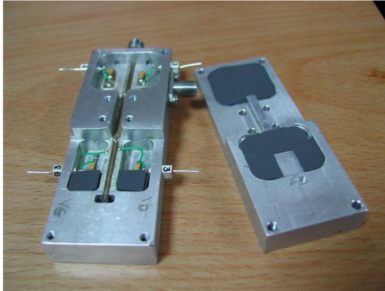
Fig. 4.5: Subsistema transmisor de RF con salida en guía
