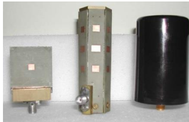
Fig. 2.7: Antena de mono parche (izda), de seis caras (centro) y monopolo (dcha)
