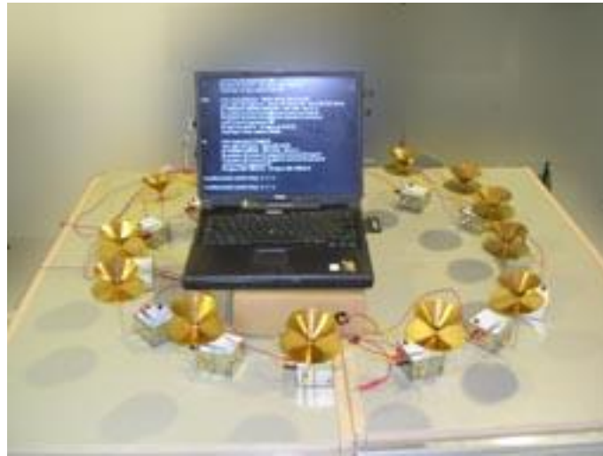
Fig. 5.11: Campaña de medidas para coexistencia entre IR-UWB y WLAN
