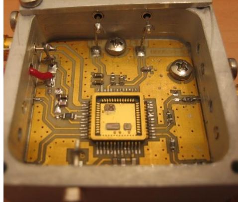
Fig. 7.6: Imágenes de los IC del transmisor integrados en SoP
