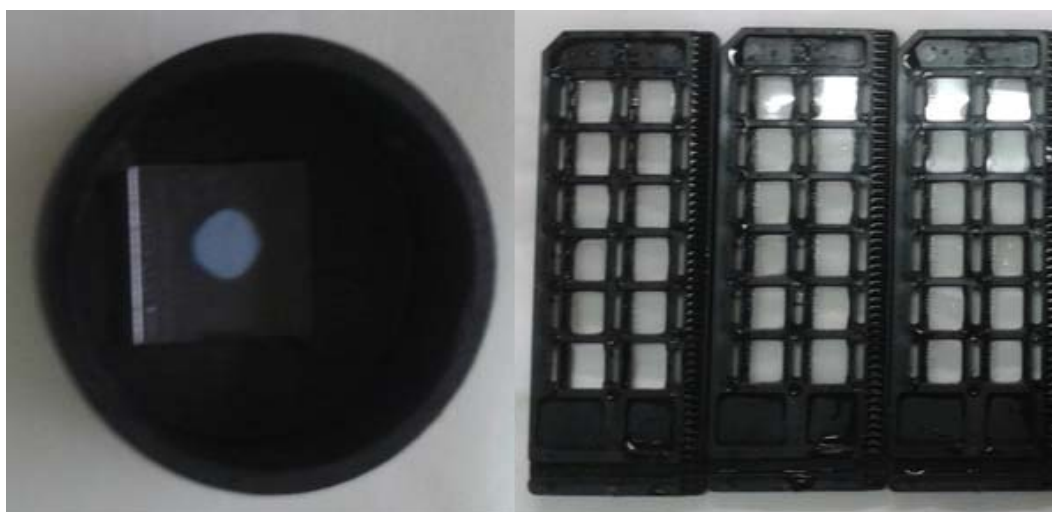
Figura 13: Detalle del detector y el porta-detectores.
