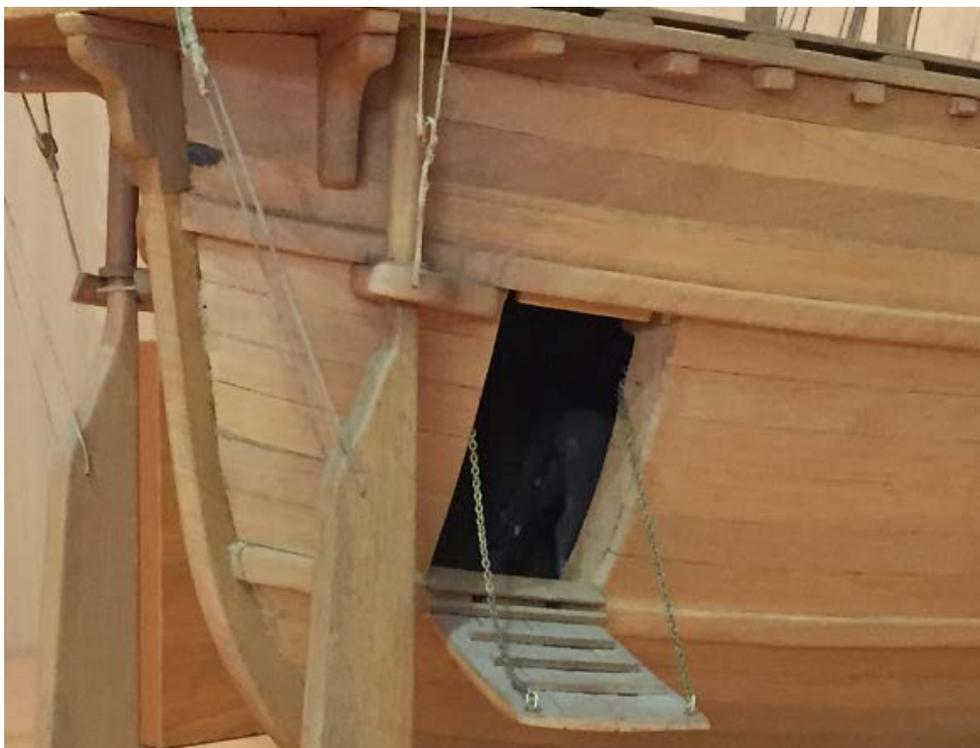
Figura 106: Detalle del portalón del modelo a escala de la tarida realizado por el Museu del Port de Tarragona. Imagen del doctorando.
