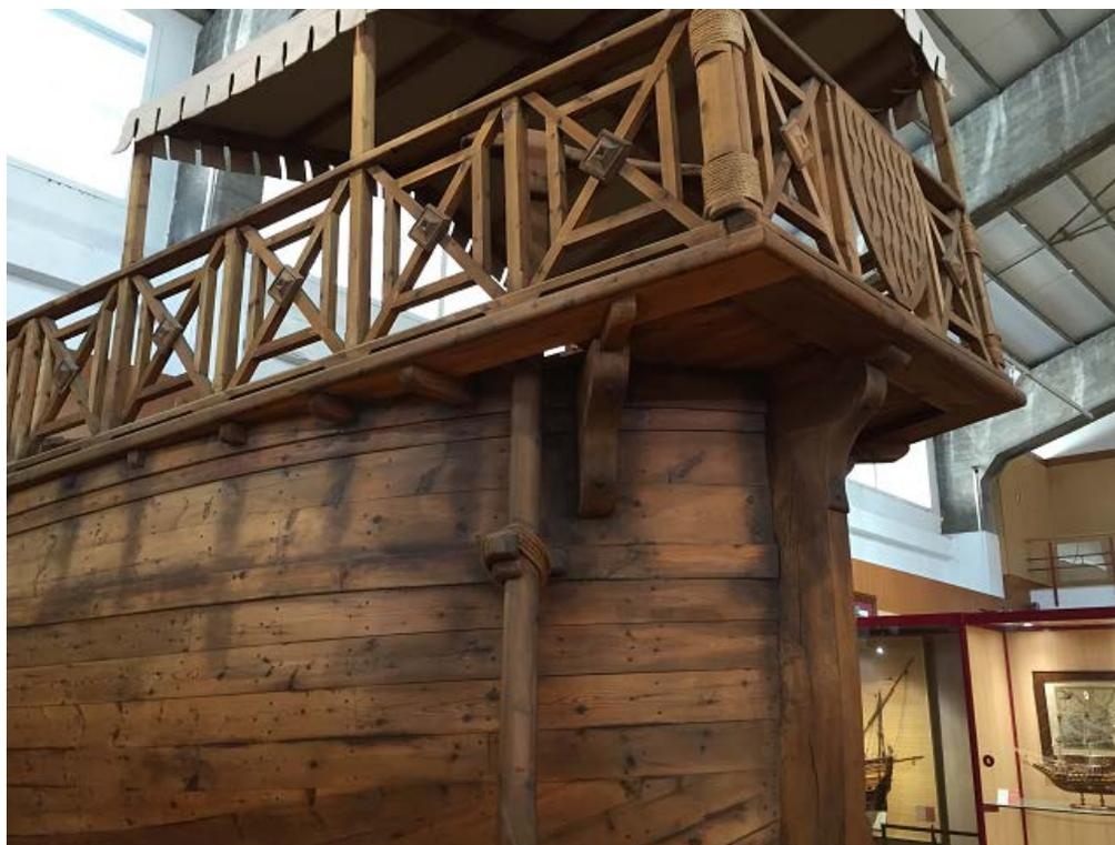
Figura 112: Detalle del timón lateral del modelo a escala real de la tarida realizado por el Museu del Port de Tarragona. Imagen del doctorando.
