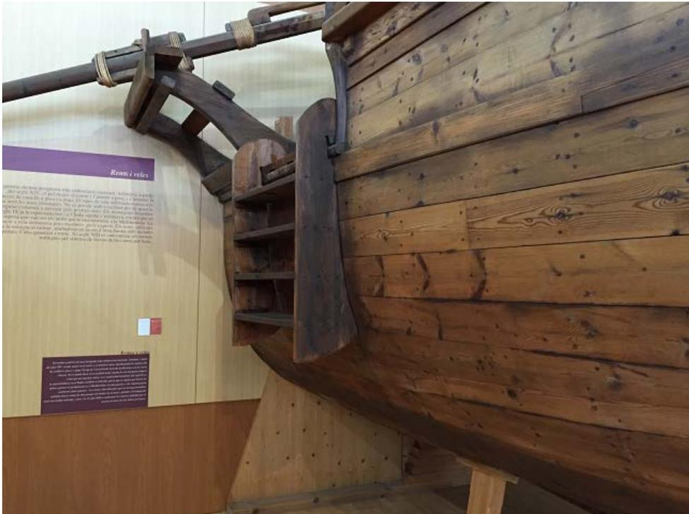
Figura 113: Detalle de la escala de embarque en el modelo a escala real de la tarida realizado por el Museu del Port de Tarragona. Imagen del doctorando.
