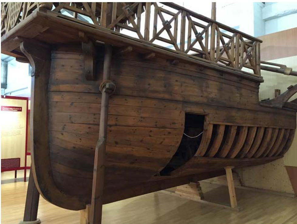
Figura 114: Detalle de la abertura en el casco correspondiente al portalón de embarque en el modelo a escala real de la tarida realizado por el Museu del Port de Tarragona. Imagen del doctorando.
