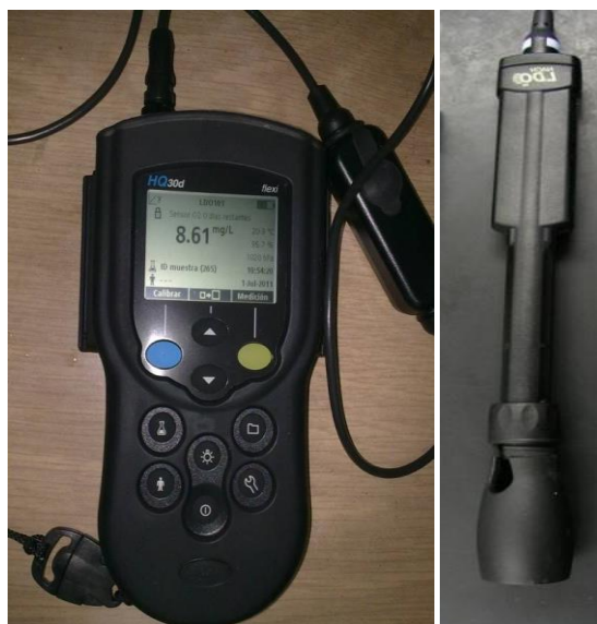
Figura IV.33. Analizador y sonda de oxígeno disuelto (Hach Company 2006).
