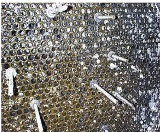
Figura II.5. Fouling helado de productos poliméricos en los tubos de un intercambiador de calor (H&C Heat Transfer Solutions Inc. 2013).
